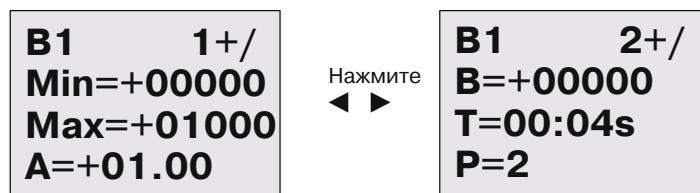
Используйте клавиши **◀** и **▶** для перехода к значениям параметров Min, Max, A, B, T и P. Используйте клавиши **▲** и **▼** для прокрутки возможных значений каждой цифры. Используйте клавишу **▶** для перехода ко второй экранной форме из последней строки первого экрана, и клавишу **◀** для перехода из верхней строки второго экрана к первому. Для применения изменений нажмите клавишу OK.
