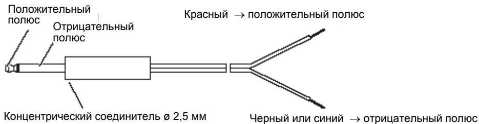
Рис. 2-6. Соединительный кабель с концентрическим соединителем
