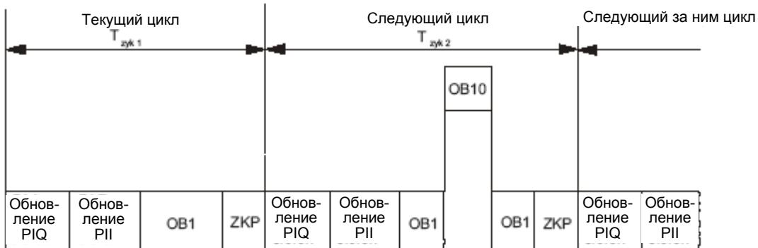
Рис. 9-2. Различные времена цикла (ZKP – точка контроля цикла)
