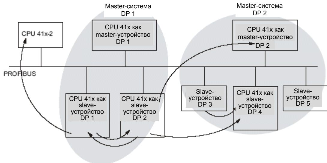
Рис. 5-6. Прямой обмен данными с CPU 41x
