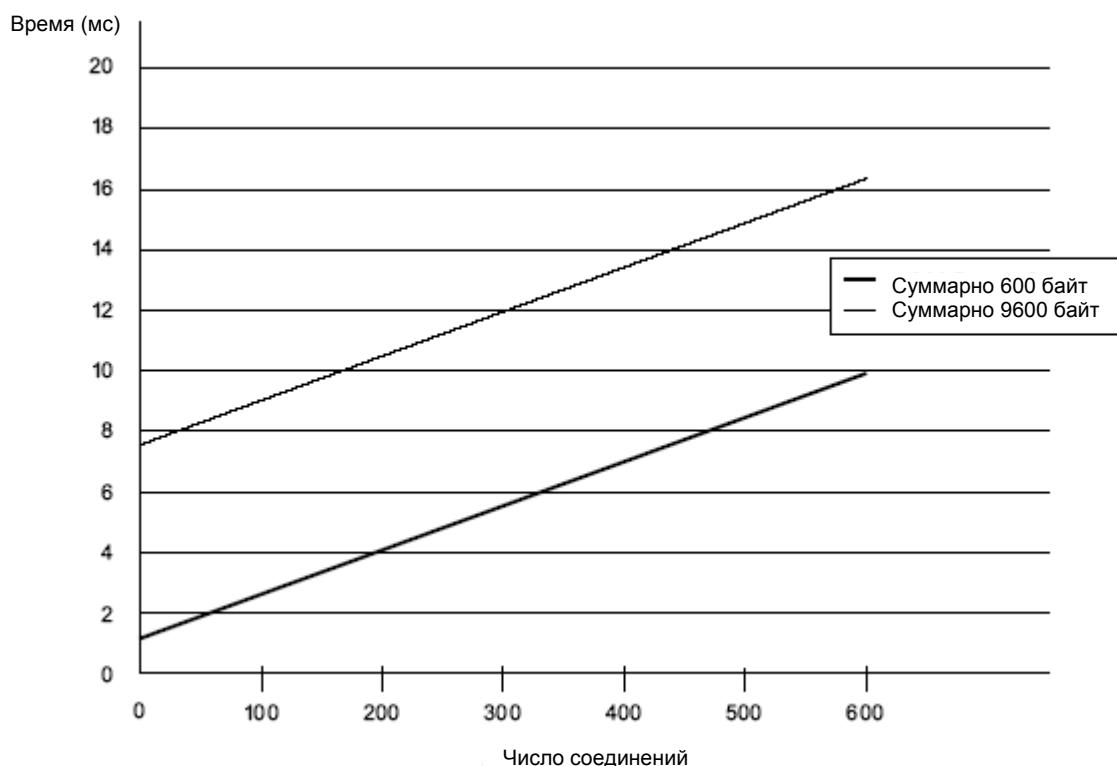
Рис. 9-11. Время обработки для передачи и приема
