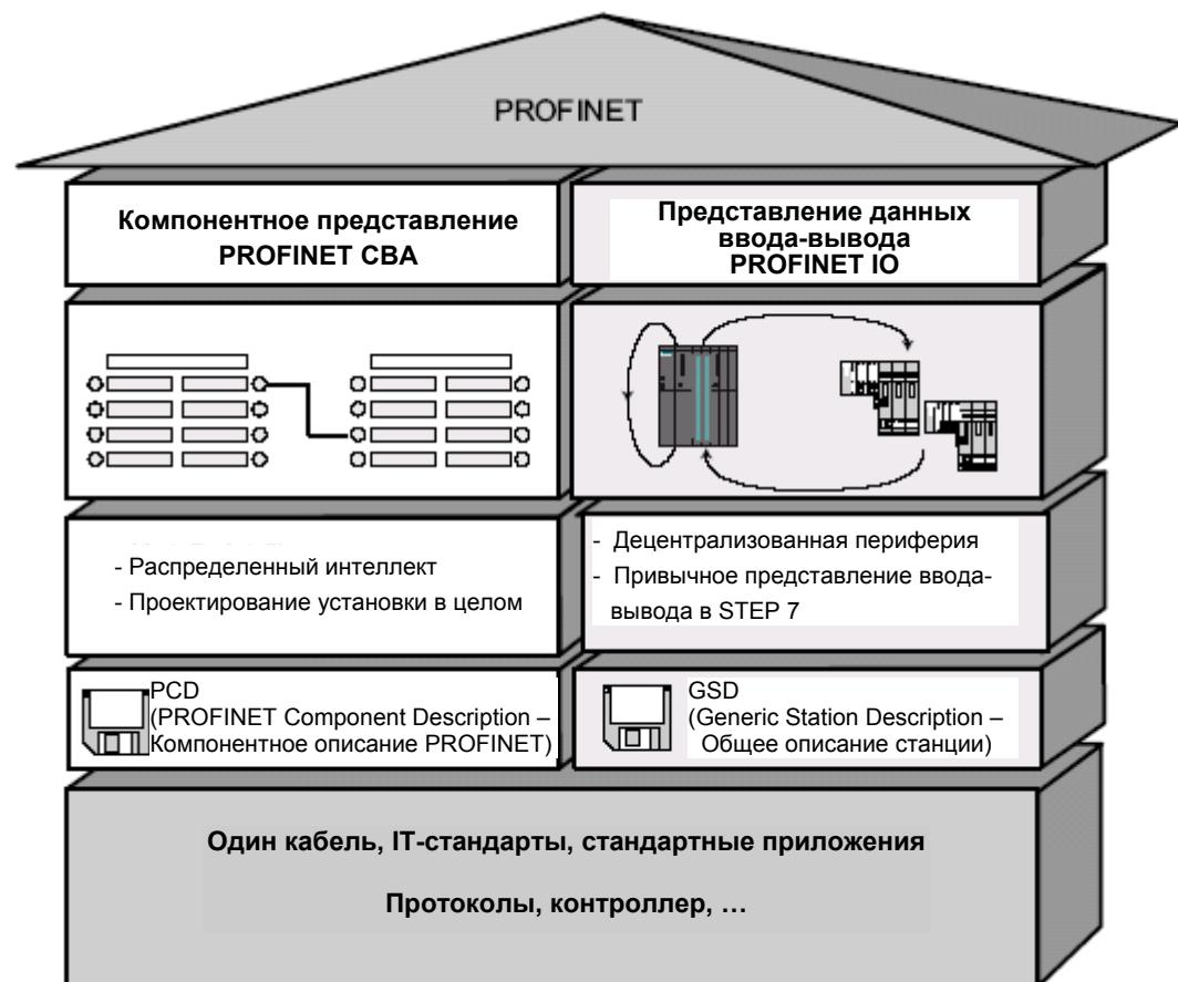
Рис. 6-1. PROFINET IO и PROFINET CBA
