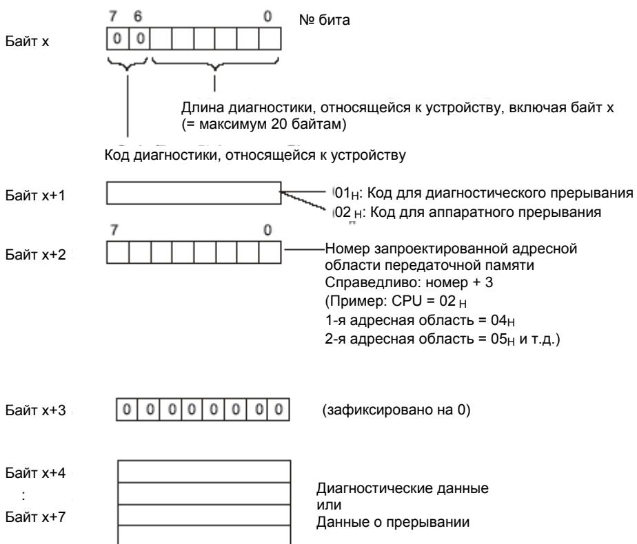
Рис. 5-4. Структура диагностики, относящейся к устройству
