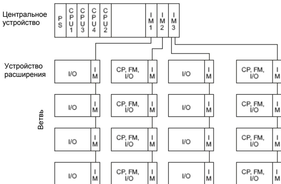
Рис. 3-1. Пример многомашинной системы
