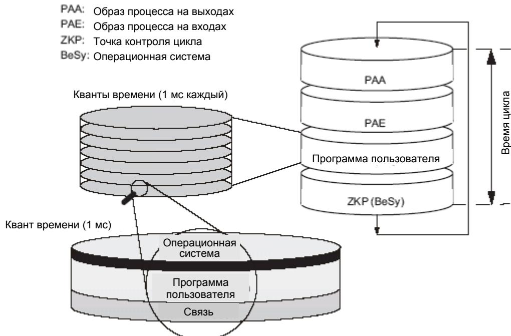
Рис. 9-1. Составные части и структура времени цикла
