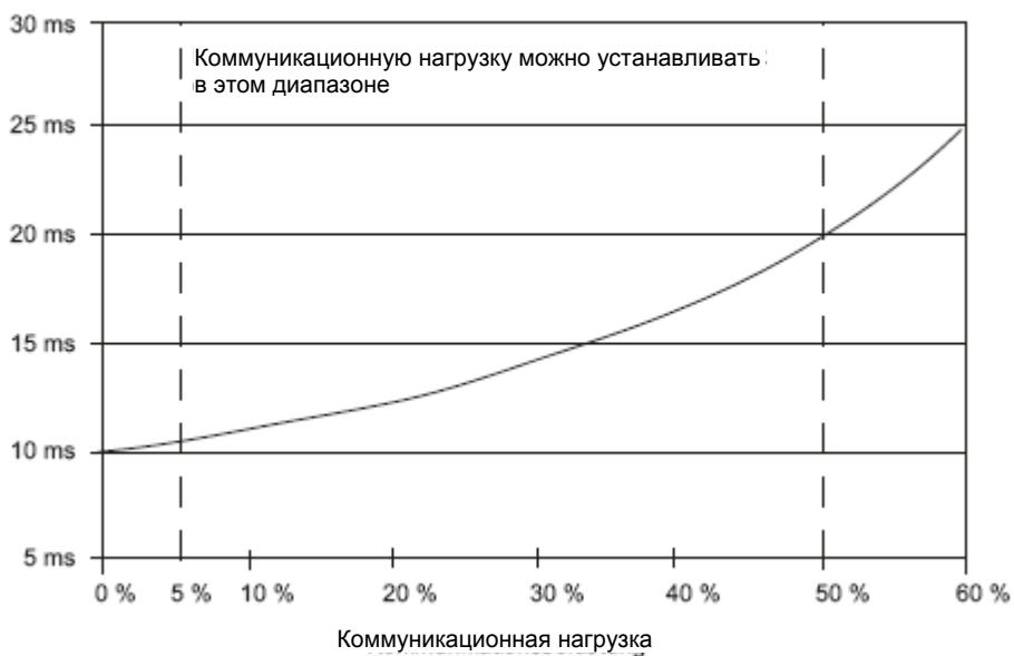
Рис. 9-6. Зависимость времени цикла от коммуникационной нагрузки
