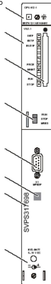
Рис. 2-1. Размещение элементов управления и индикации на CPU 412-1
