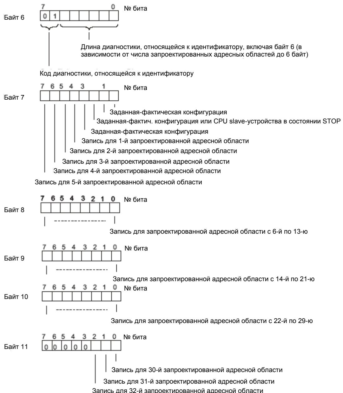
Рис. 5-3. Структура относящейся к идентификатору диагностики CPU 41x
