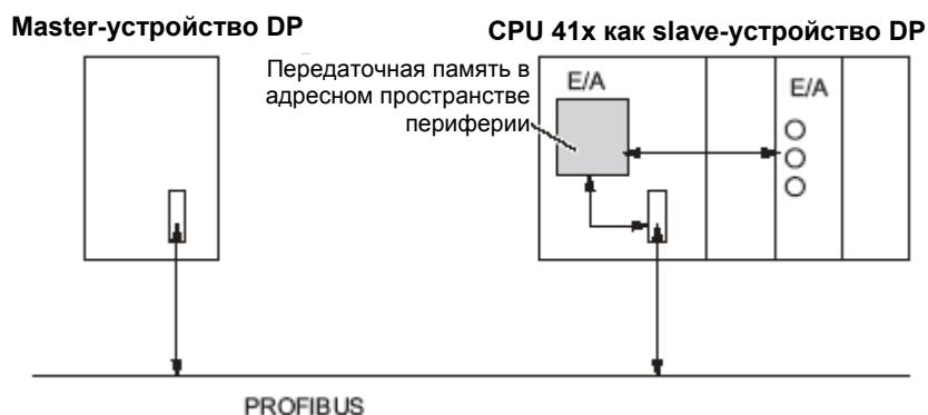
Рис. 5-2. Передаточная память в CPU 41x как slave-устройство DP
