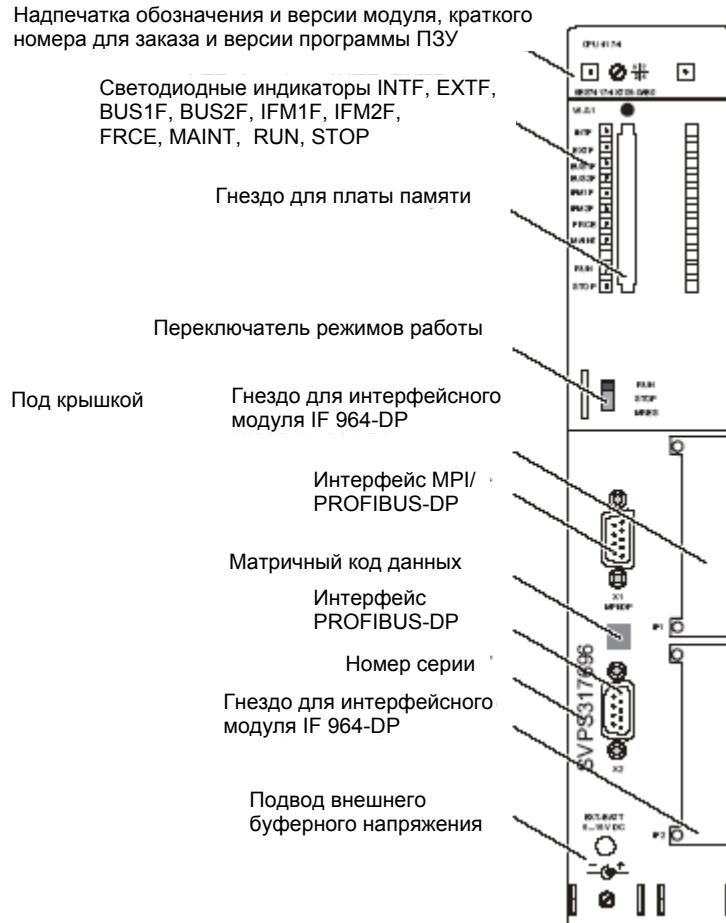
Рис. 2-5. Размещение элементов управления и индикации на CPU 417-4
