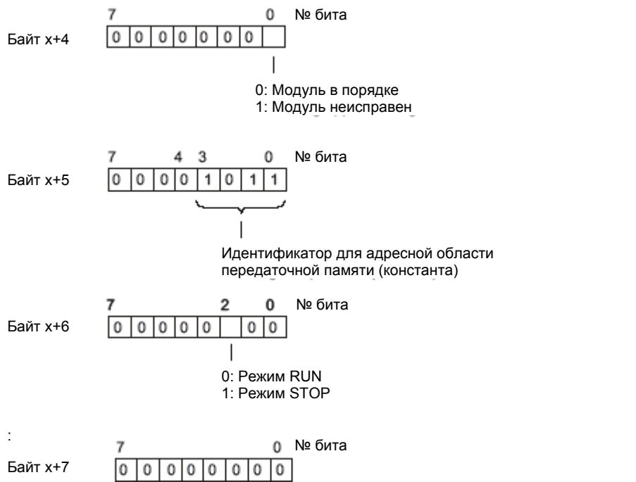
Рис. 5-5. Байты от x+4 до x+7 для диагностического и аппаратного прерывания
