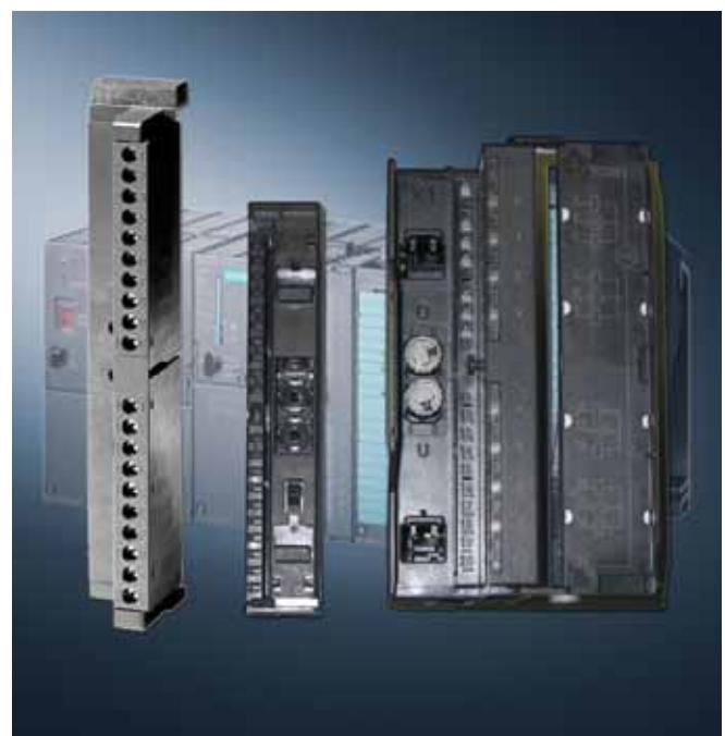
При первой установке фронтального соединителя на модуль автоматически выполняется операция его механического кодирования. В дальнейшем фронтальный соединитель может быть установлен только на модули такого же типа, что исключает возможность возникновения ошибок при замене модулей. Фронтальный соединитель не входит в комплект поставки модуля и должен заказываться отдельно.
