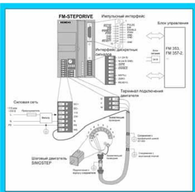
357-2 или системой числового программного управления SINUMERIK 802S. На корпусе секции расположены контакты для подключения внешнего источника питания, подключения цепи питания двигателя, подачи импульсов и сигналов управления направлением вращения.
