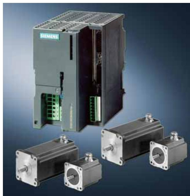
Силовая секция FM STEPDRIVE предназначена для управления шаговыми двигателями SIMOSTEP серии 1FL3 мощностью от 5 до 600 Вт. Секция ориентирована на использование в системах высокоточного позиционирования, работающих под управлением функциональных модулей FM 353 и FM 357-2, а также систем SINUMERIK 802S. Секция способна управлять работой шаговых двигателей с врачающим моментом от 2 до 15 Нм.
