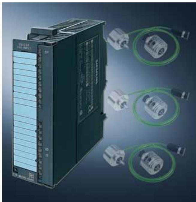
Модуль SM 338 POS предназначен для работы в составе программируемых контроллеров SIMATIC S7-300, а также станций распределенного ввода-вывода ET 200M. Модуль позволяет производить подключение до трех синхронно-последовательных (SSI) датчиков абсолютного перемещения и передавать результаты измерений в центральный процессор.
