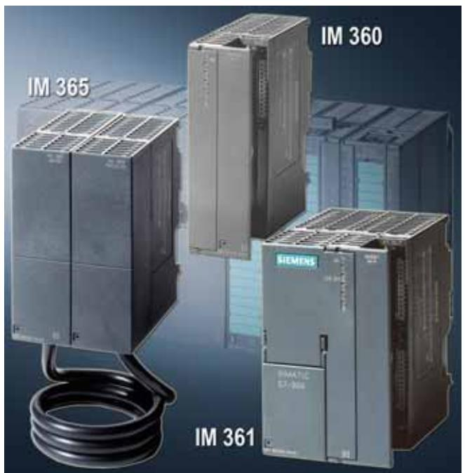
За интерфейсными модулями резервируется 3-е посадочное место монтажной стойки (после блока питания и центрального процессора). Это правило справедливо для всех монтажных стоек, даже если в них отсутствуют блоки питания и центральные процессоры.
