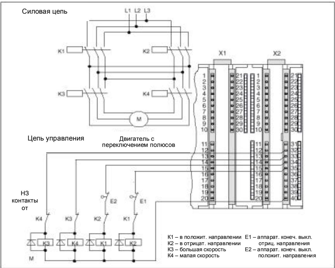
В следующих распределениях контактов штекеров описаны только те присоединения, которые имеют значение для соответствующего вида позиционирования. Остальные присоединения вы найдете в руководстве в главе “Подключение”.
