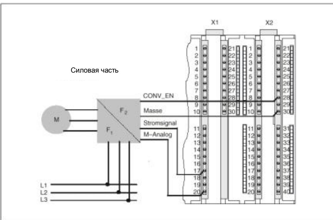
Пояснения к рисунку: Masse – масса; Stromsignal – токовый сигнал; M-Analog – масса для аналогового сигнала
