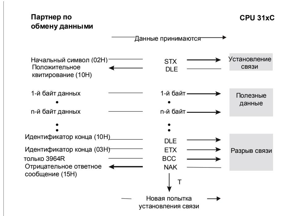
После приема DLE, ETC, BCC CPU сравнивает BCC партнера по обмену данными с собственным внутренне сформированным значением. Если BCC верен и нет других ошибок приема, то CPU отвечает передачей DLE.
