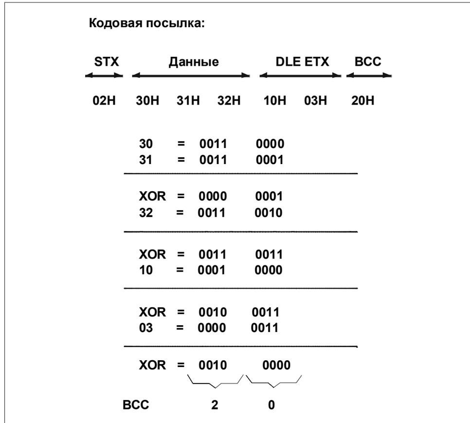
Контрольная сумма блока реализует контроль четности длины (логического сопряжения всех байтов данных с использованием исключающего ИЛИ) передаваемого или принимаемого блока. Ее формирование начинается с первого байта полезных данных (1-й байт кадра сообщения) после установления соединения и заканчивается после символа DLE ETX при разрыве соединения.
