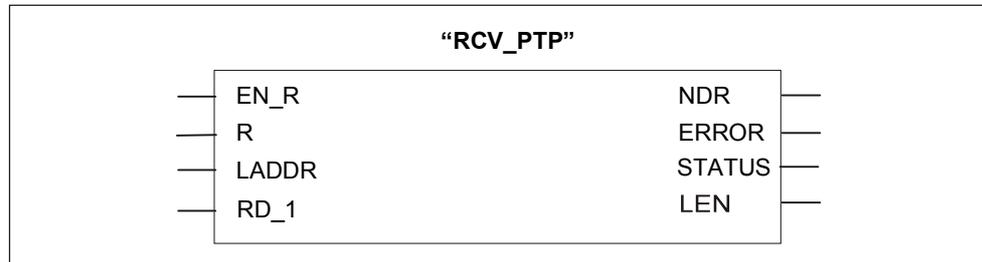
Блок готовится к приему после вызова значением TRUE на управляющем входе **EN\_R**. Текущую передачу можно прекратить с помощью состояния сигнала FALSE на параметре EN\_R. Прерванное задание завершается с сообщением об ошибке (выход **STATUS**). Прием выключается, пока на параметре EN\_R сохраняется состояние FALSE.
