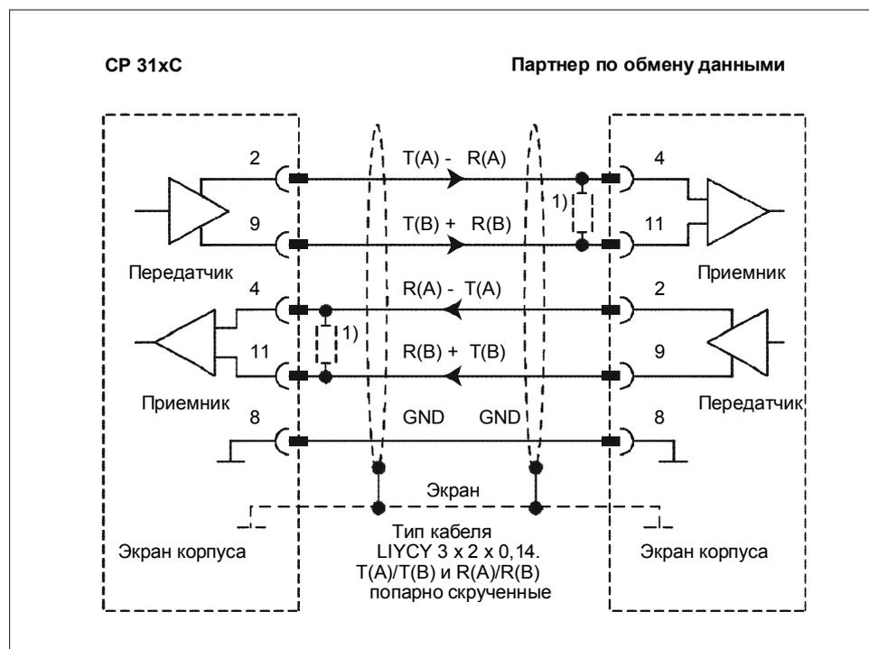
1) При длинах кабеля > 50 м вы должны для бесперебойного обмена данными впаять на стороне приемника оконечное сопротивление около 330 Ом.
