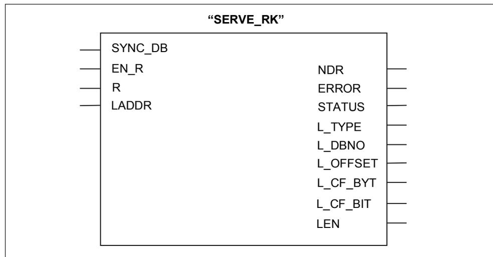
SFB готов к действию после вызова со значением TRUE на управляющем входе EN\_R. Текущую передачу можно прекратить с помощью состояния сигнала FALSE на параметре EN\_R. Прерванное задание завершается с сообщением об ошибке (выход STATUS). Прием выключается, пока на параметре EN\_R сохраняется состояние FALSE.
