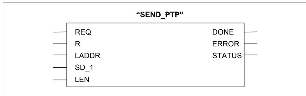
Активизация процесса передачи производится после вызова блока и положительного фронта на управляющем входе **REQ**. Область подлежащих передаче данных задается через **SD\_1** (номер DB и начальный адрес), длина блока передаваемых данных через **LEN**.
