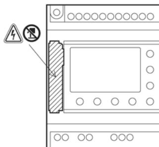
1) Отсоединение крышки или кассеты запоминающего устройства
