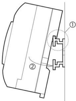
Совместите верхний край канавки, имеющейся на корпусе контроллера серии "Альфа-2", и предназначенный для монтажа на рельсе в стандарте DIN, с краем рельса (1), и надвиньте устройство на рельс.
