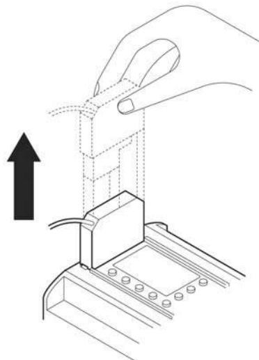
4) Установка на место крышки или кассеты запоминающего устройства
