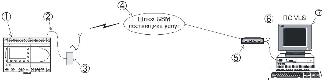
**Таблица 1.5: Конфигурация для программирования/контроля через GSM модем**
