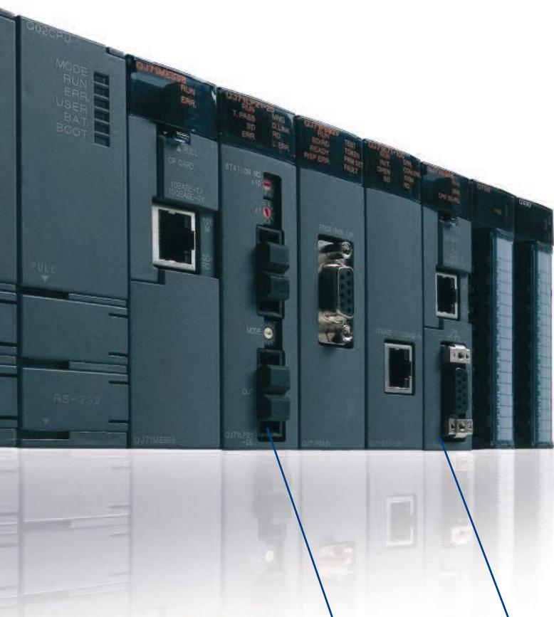
Программирование и техническое обслуживание облегчают яркие светодиодные индикаторы режимов работы
