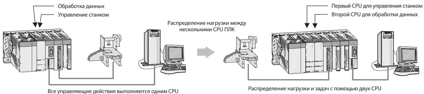
Если нагрузка, приложенная к большой системе, превышает вычислительные возможности CPU из-за большого размера программы, то использование нескольких CPU для распределения нагрузки улучшает общую производительность системы.
