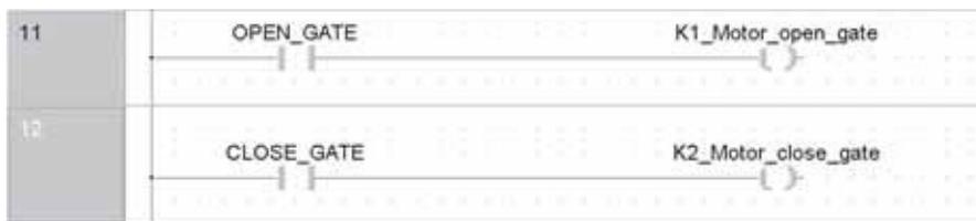
В конце программы состояния сигналов локальных переменных для открывания и закрывания передаются на выходы Y11 и Y12.
