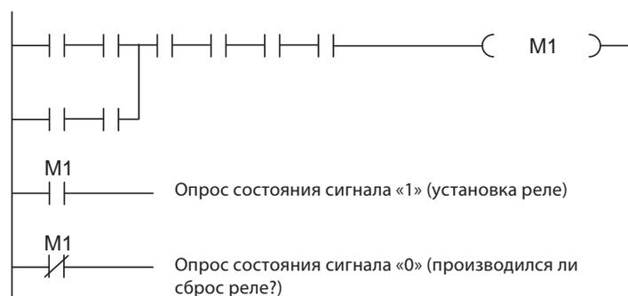
Помимо обычных реле в контроллерах серии System Q используются также запоминающие или «фиксируемые» реле. Все обычные нефиксируемые реле при отключении питания ПЛК сбрасываются в состояние сигнала «0», которое также является стандартным при включении контроллера. В отличие них фиксируемые реле сохраняют свое текущее состояние при отключении и последующем включении питания.
