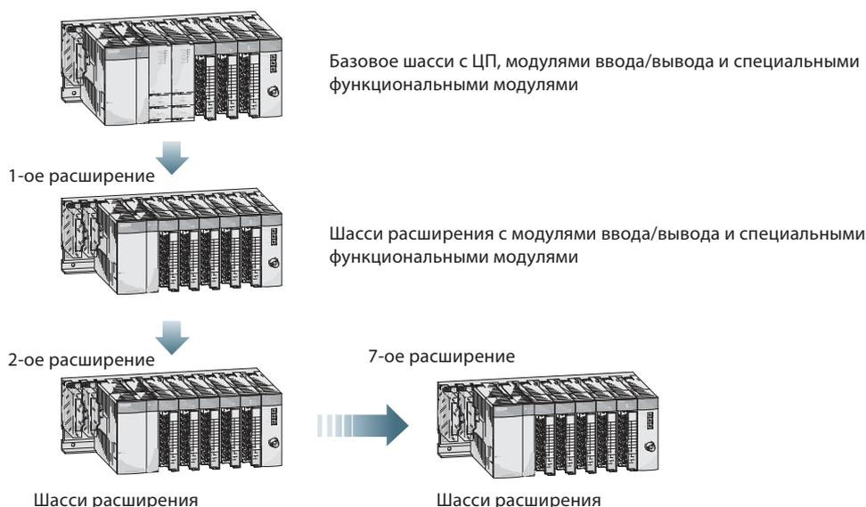
При выборе модуля питания необходимо учитывать общую потребляемую мощность модулей ввода/вывода, специальных функциональных модулей и периферийных устройств. В случае необходимости следует использовать шасси расширения с дополнительным модулем питания.
