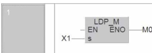
Чтобы ввести переменную в выход функции, щёлкните кнопку
