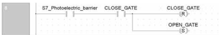
При обнаружении фотоэлементом препятствия при закрывании двери движение останавливается и дверь снова открывается.
