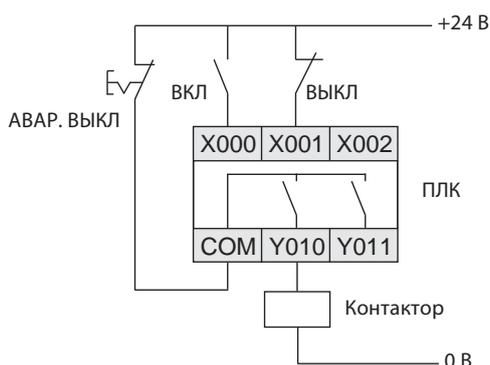
В данном примере контактор системы привода можно также выключать вручную с помощью выключателя АВАР. ВЫКЛ.
