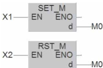
Если при оценке команд установки и сброса для одного устройства в обоих случаях получается «1», приоритет имеет операция, выполнявшаяся последней. В данном примере это команда RST, поэтому M0 остается выключенным.
