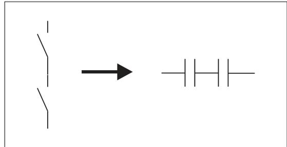
В данном пакете для программирования для команд AND и ANI используются такие же значки и функциональные клавиши, как для команд LD и LDI. При программировании в формате Ladder Diagram правильное назначение команд производится автоматически, на основе позиции вставки.
