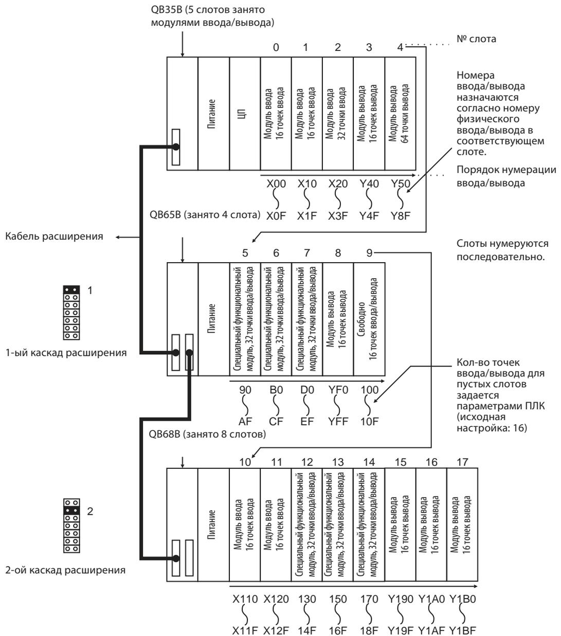
Каскад расширения определяется установкой перемычек на шасси расширения.
