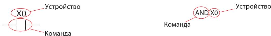
Данная команда описывает что нужно сделать, т.е. функцию, которую должен выполнить контроллер. Операнд или устройство – это объект действия данной функции. Его обозначение состоит из двух частей: имени устройства и адреса устройства:
