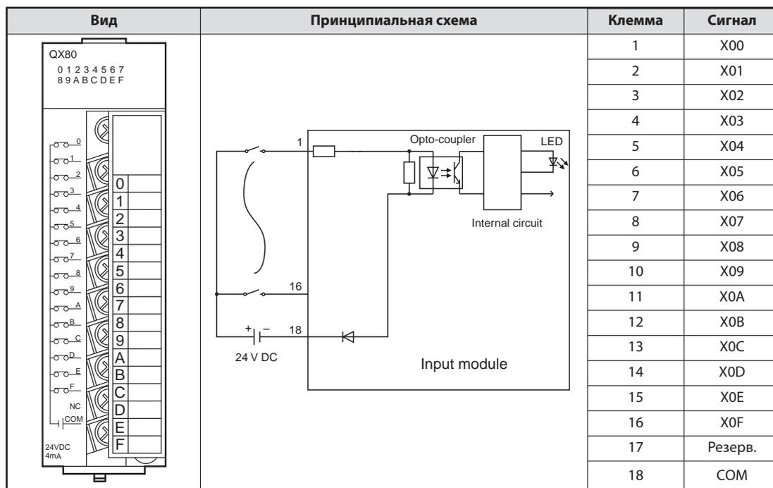
**Принцип работы модуля входов с общим минусом**
