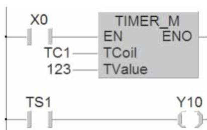
В качестве переменной для входа TCoil команды TIMER\_M указан адрес устройства таймера (в данном примере TC1).
