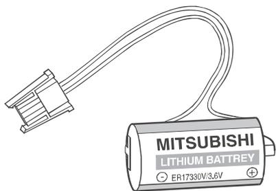
Модуль ЦП ПЛК серии System Q снабжен батареей. При сбое электропитания батарея обеспечивает хранение данных в памяти программы, питание встроенного ОЗУ и часов в течение нескольких тысяч часов. Однако период времени зависит от типа ЦП.
