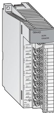
Модули аналоговых входов System Q отличаются сочетанием высокого разрешения (0,333 мВ/1,33 мкА) и высокой скорости преобразования (80 мкс на канал).
