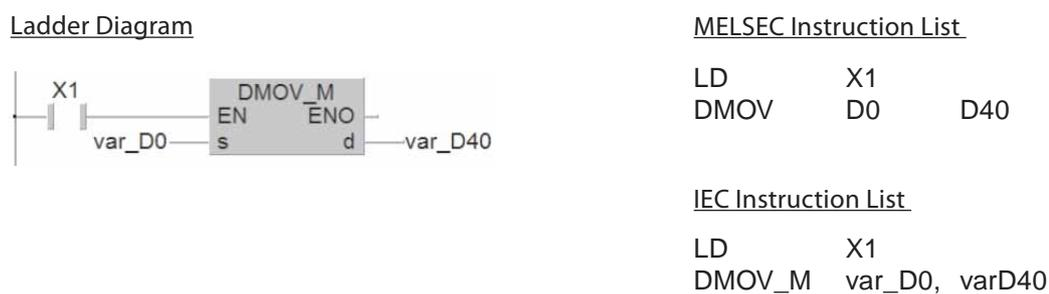
Когда вход X1 включен, содержимое регистров данных D0 и D1 записывается в регистры D40 и D41 (содержимое D0 копируется в D40, содержимое D1 в – D41).
