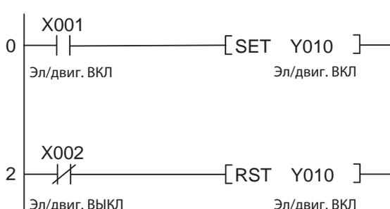
В программе для данной монтажной схемы замыкающий контакт выключателя ВКЛ опрашивается командой LD, а размыкающий контакт выключателя ВЫКЛ – командой LD1. Выход (соответственно, и привод тоже) отключается, когда состояние сигнала входа X002 становится равным «0». Это происходит при задействовании выключателя ВЫКЛ или прерывании соединения между данным выключателем и входом X002.
