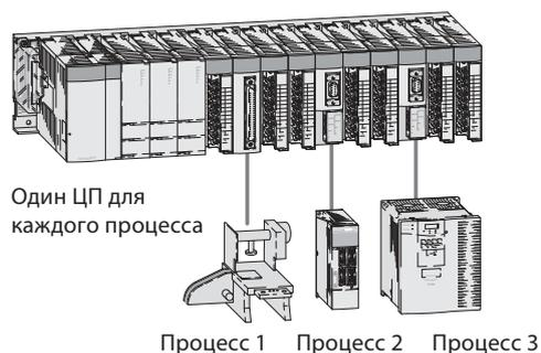
Если из-за большого объема программы нагрузка на крупномасштабную систему превышает возможности обработки, использование нескольких ЦП для распределения нагрузки улучшает производительность всей системы.
