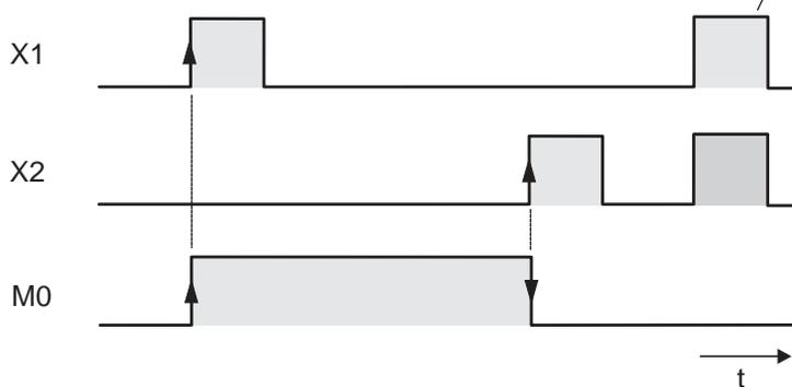
Данный пример представляет программу управления насосом, заполняющим некоторую ёмкость. Управление насосом осуществляется вручную, с помощью кнопок ВКЛ и ВЫКЛ. По соображениям безопасности для функции ВЫКЛ используется размыкающий контакт. Когда ёмкость заполняется, датчик уровня автоматически отключает насос.
