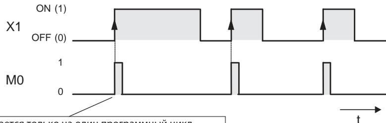
Реле M0 включается только на один программный цикл
