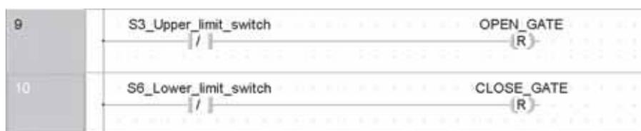
Если дверь открыта, активируется концевой выключатель S3 и вход X3 отключается. При этом сбрасывается локальная переменная OPEN\_GATE и электродвигатель останавливается.
