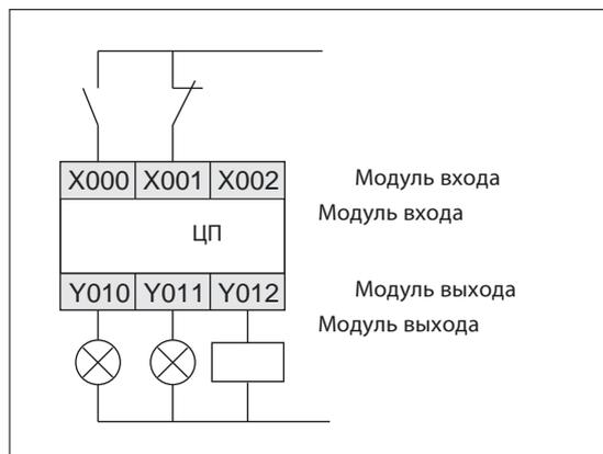
На рисунке слева показан пример подключения выключателей к входам, а ламп и контакторов к выходам ПЛК серии System Q.
