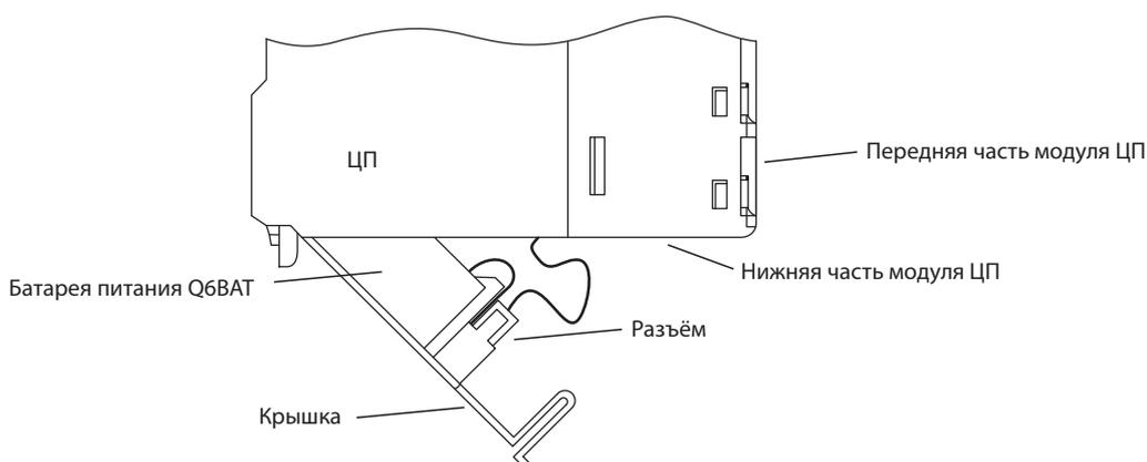
Чтобы подключить батарею, откройте крышку батарейного отсека модуля ЦП. Убедитесь, что батарея установлена правильно. Вставьте разъём батареи в гнездо на корпусе. При использовании модулей ЦП Q02(H), Q06H, Q12(P)H и Q25(P)H CPU разъём вставляется в соответствующий держатель, расположенный на крышке батарейного отсека.
