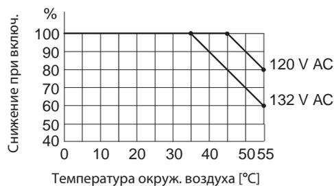
Для модуля QX10 количество входов, которые можно включить одновременно, зависит от температуры окружающего воздуха.
