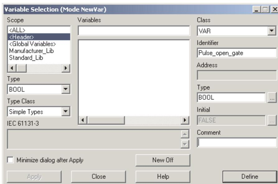
Щёлкните кнопку Define (Определить) для ввода новой переменной в список локальных переменных (локальный заголовок программного модуля).
