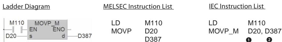
После выполнения данного одноразового копирования прекращается копирование в регистр D387, даже если M110 остается установленным. Последовательность сигнала выглядит следующим образом.
