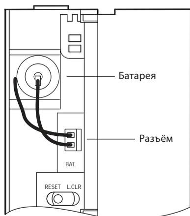
На модулях ЦП Q00J, Q00 и Q01 батарея устанавливается за верхней крышкой в передней части модуля ЦП.
