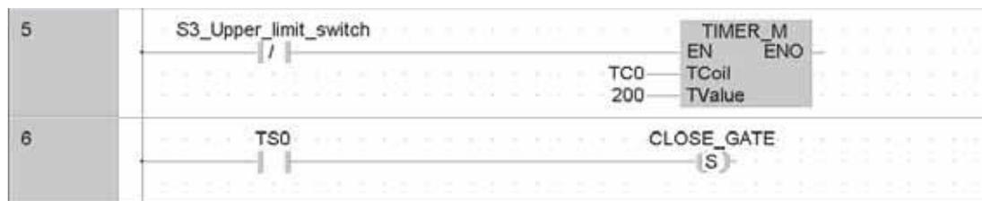
Если дверь открыта, активируется концевой выключатель S3 и вход X3 отключается (по соображениям безопасности в S3 используется размыкающий контакт). После этого таймер T0 начинает отсчет 20-секундной задержки ( $K200 = 200 \times 0,1 \text{ с} = 20 \text{ с}$ ). Через 20 с по таймеру дверь закрывается.
