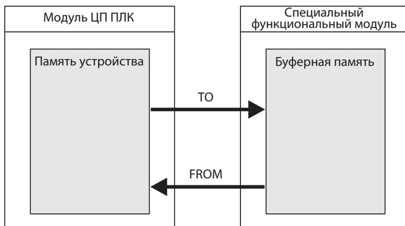
Буферная память рассчитана на 32767 отдельных адресуемых ячеек памяти, в каждой из которых может храниться 16 бит данных. Функции ячеек буферной памяти зависят от конкретного специального функционального модуля, подробные сведения приведены в документации для модуля.
