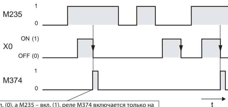
Когда X0 – выкл. (0), а M235 – вкл. (1), реле M374 включается только на один программный цикл
