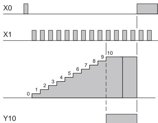
Сначала счётчик сбрасывается с помощью входа X0 и команды RST. При этом обнуляется значение счётчика и отключается его выход.
