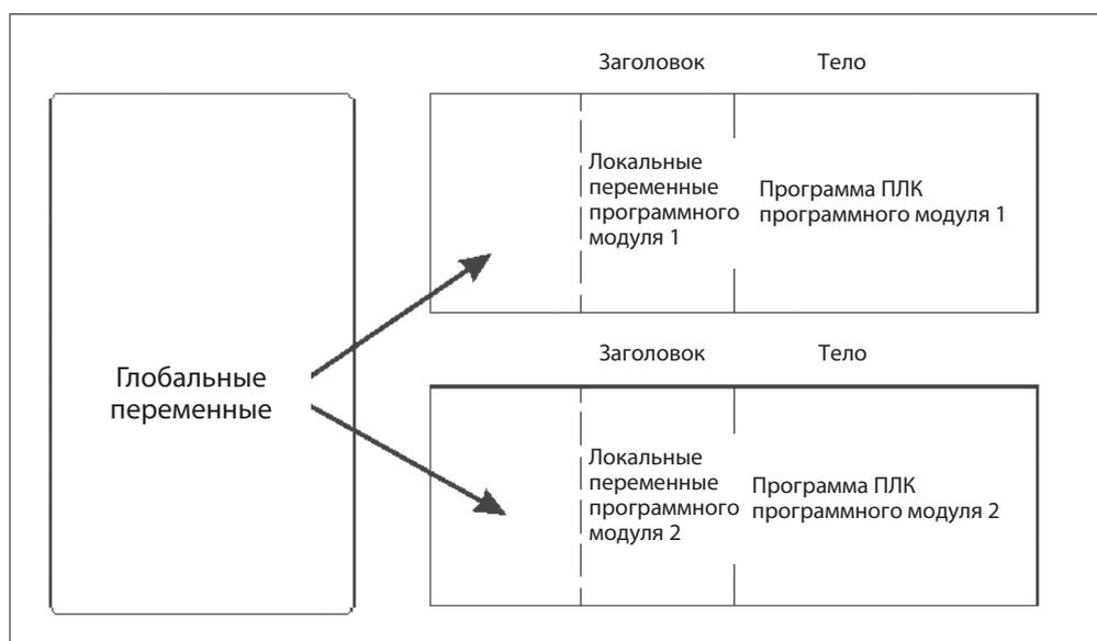
Для доступа программного модуля к какой-то глобальной переменной она должна быть объявлена в заголовке данного модуля. В заголовок могут входить как глобальные переменные, так и локальные.
