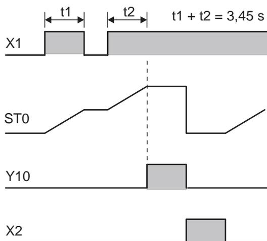
Когда X1 включен, таймер считает внутренние 10-мс импульсы. При отключении X1 сохраняется текущее показание счётчика времени. Когда текущее значение достигает значения уставки таймера, включается выход таймера.
