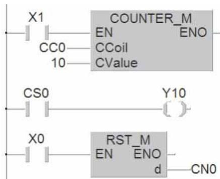
В качестве переменной для входа CCoil команды COUNTER\_M указан адрес устройства счётчика (в данном примере **CC0**).
