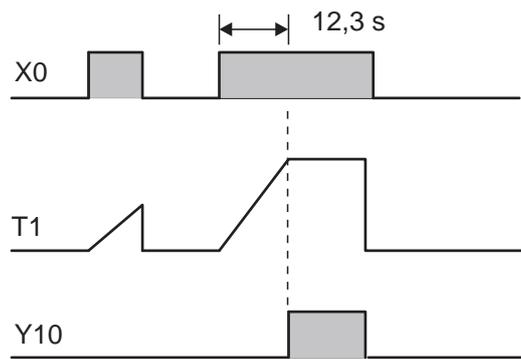
Таймер считает внутренние 100-мс импульсы, пока X0 остается включенным. При достижении значения уставки выход T1 отключается.
