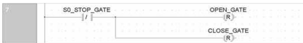
При нажатии кнопки СТОП сбрасываются две локальные переменные и электродвигатель привода останавливается.
