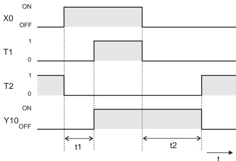
Когда включается X0, запускается T1 и сбрасывается T2. По истечении периода задержки t1 включается выход Y10. Он остается включенным, пока включен X0.
