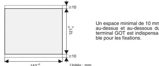
Un espace minimal de 10 mm au-dessus et au-dessous du terminal GOT est indispensable pour les fixations.
