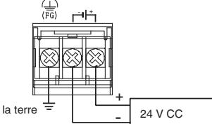
Utilisez des fils de section minimale 0,75 mm² pour éviter les chutes de tension ; serrez les vis des bornes à un couple compris entre 0,5 et 0,8 Nm.
