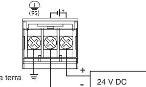
Per ridurre la caduta di tensione, utilizzare linee con la massima sezione possibile (max. 2 mm<sup>2</sup>) e torcere i singoli fili fino a poco prima dei morsetti d'attacco. Stringere le viti nei morsetti applicando una coppia di serraggio compresa tra 0,5 e 0,8 Nm.
