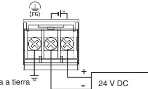
Utilice cables con una sección de 0,75 mm<sup>2</sup> o superior para evitar una fuerte caída de tensión y apriete firmemente los tornillos de los bornes a un par de 0,5 hasta 0,8 Nm.
