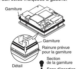
③ Faites passer le pupitre opérateur par la face avant de l'armoire de distribution ou de l'armoire-pupitre à travers la découpe du panneau de distribution.
