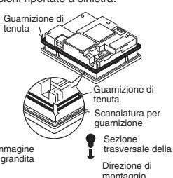
③ Inserire il dispositivo di comando dal lato anteriore del quadro elettrico e del banco attraverso l'apertura eseguita sul quadro di comando.
