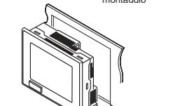
④ Inserire gli elementi di fissaggio in dotazione nella fessura laterale del GOT. Utilizzare tutti e quattro gli elementi di fissaggio e stringere le viti con una coppia da 0,3 a 0,5 Nm.
