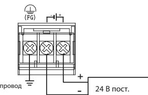
Во избежание падения напряжения используйте для подключения питания провода сечением не менее 0,75 mm<sup>2</sup>. Надёжно затяните винтовые клеммы моментом 0,5–0,8 Нм.
