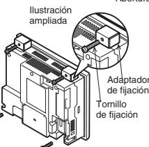
Tras la fijación, retire la película protectora del display del terminal de operador.
