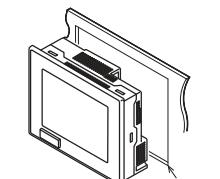
④ Engagez le crochet de fixation (fourni) dans le trou de fixation du terminal GOT et serrez la vis. Utilisez les 4 fixations fournies et serrez les vis de fixation à un couple compris entre 0,3 et 0,5 Nm.
