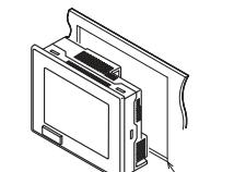
④ Enganche el gancho del adaptador de fijación (suministrado) a las aberturas laterales de fijación del terminal GOT y apriete los tornillos de fijación hasta que el GOT quede inmovilizado. Asegúrese de utilizar los cuatro adaptadores mostrados y apriete los tornillos de fijación a un par de 0,3 hasta 0,5 Nm.
