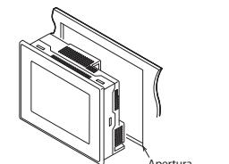
④ Inserire gli elementi di fissaggio in dotazione nella fessura laterale del GOT. Utilizzare tutti e quattro gli elementi di fissaggio e stringere le viti con una coppia da 0,3 a 0,5 Nm.
