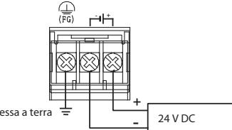
Per ridurre la caduta di tensione, utilizzare linee con la massima sezione possibile (max. 2 mm<sup>2</sup>) e torcere i singoli fili fino a poco prima dei morsetti d'attacco. Stringere le viti nei morsetti applicando una coppia di serraggio compresa tra 0,3 e 0,8 Nm.
