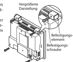
Entfernen Sie nach der Montage die Schutzfolie von der Anzeige.
