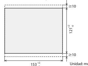
Debe dejarse un espacio de como mínimo 10 mm en los lados superior e inferior del GOT con el fin de permitir la sujeción de los adaptadores de montaje.
