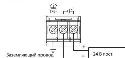
Во избежание падения напряжения используйте для подключения питания провода сечением не менее 0.75 mm<sup>2</sup>. Надёжно затяните винтовые клеммы моментом 0.5–0.8 Nm.
