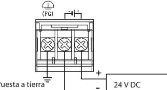
Utilice cables con una sección de 0,75 mm<sup>2</sup> o superior para evitar una fuerte caída de tensión y apriete firmemente los tornillos de los bornes a un par de 0,5 hasta 0,8 Nm.
