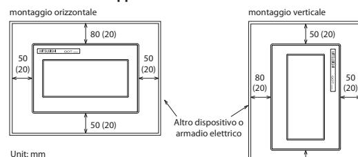
Si richiedono minimo 100 (20) mm di spazio libero sul retro del GOT. I valori in parentesi valgono per il caso in cui nelle vicinanze del GOT non siano installati dispositivi, quali ad esempio contatori, che generano disturbi elettromagnetici o emettono calore.
