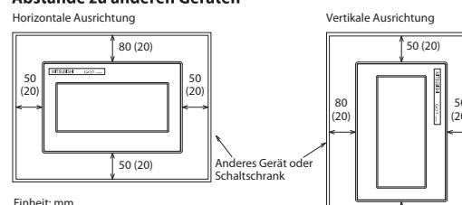
An der Rückseite des GOT ist ein Freiraum von mindestens 100 (20) mm erforderlich. Die Werte in Klammern gelten für den Fall, dass in der Nähe des GOT keine Geräte wie z. B. Schütze installiert sind, die elektromagnetische Störungen erzeugen oder die Hitze ausstrahlen.
