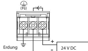
Verwenden Sie zur Reduzierung des Spannungsabfalls Leitungen mit einem Querschnitt von mindestens 0,75 mm². Ziehen Sie die Schrauben der Klemmen mit einem Moment von 0,5 bis 0,8 Nm an.
