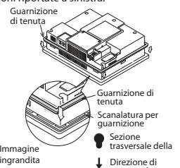
③ Inserire il GOT dal lato anteriore del quadro elettrico e del banco attraverso l'apertura eseguita sul quadro di comando.
