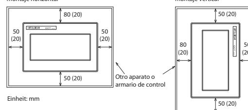
En la cara posterior del GOT se necesita un espacio libre de 100 (20) mm como mínimo. Los valores indicados entre paréntesis son de aplicación cuando no estén instalados cerca otros equipos que generen interferencias radiadas (tales como los contactores) o calor.
