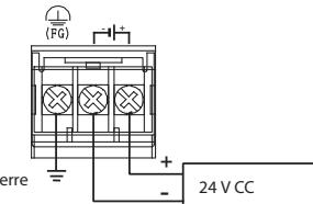
Utilisez des fils de section minimale 0,75 mm<sup>2</sup> pour éviter les chutes de tension ; serrez les vis des bornes à un couple compris entre 0,5 et 0,8 Nm. Veuillez utiliser pour le raccordement de la tension d'alimentation des cosses à oeillet ou à fourche pour vis M3 (voir ci-dessous).
