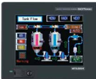
GOT1000 - типичная графическая панель оператора
