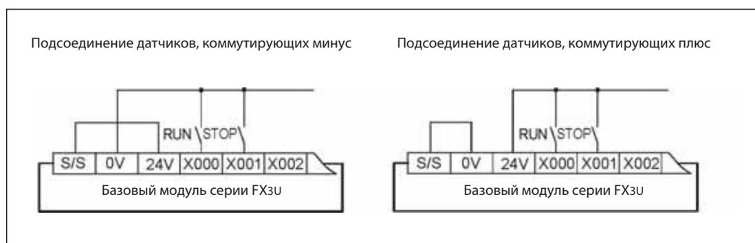
**Рис. 6-29:** В этом примере для запуска контроллера используется вход X000, а для останова - вход X001.
