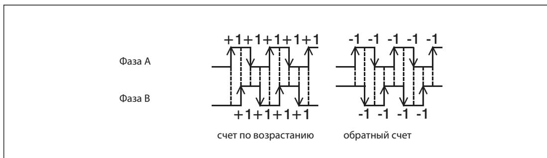
**Рис. 15-6:** Вид счета при регистрации 4 фронтов 2-фазным счетчиком
