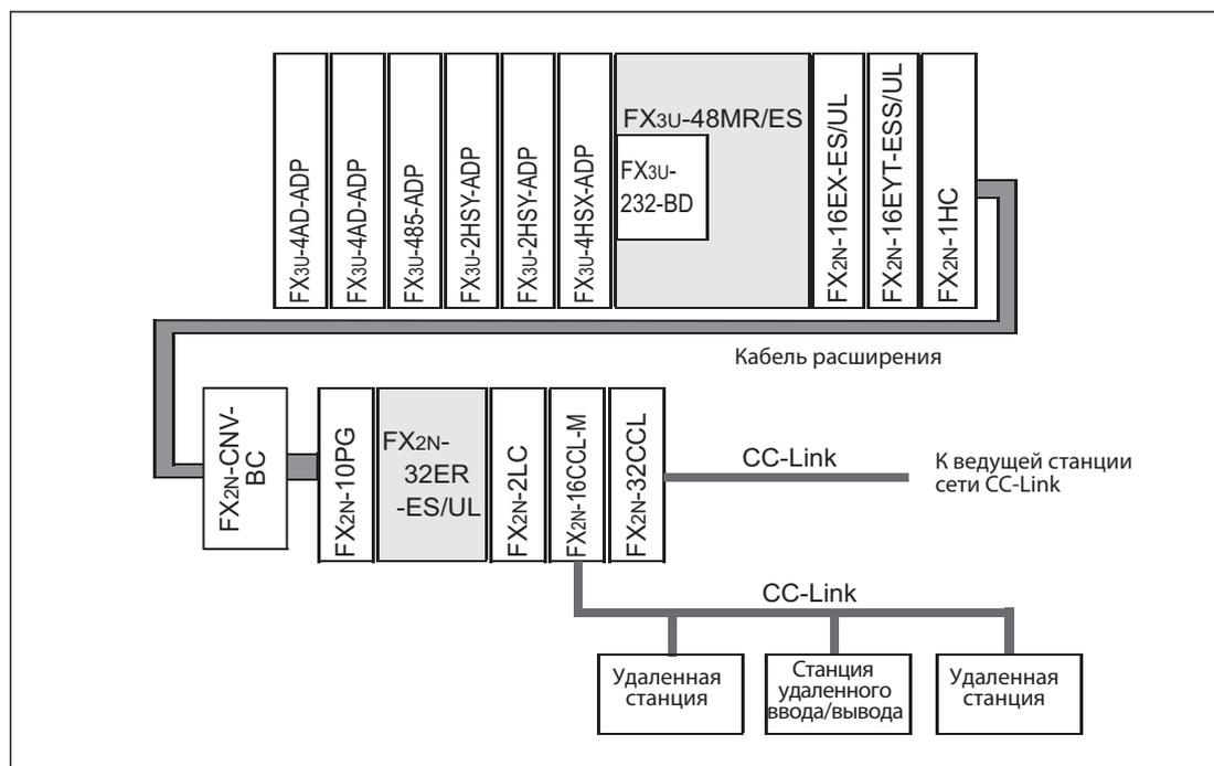
Рис. 2-28: Измененная конфигурация с компактным модулем расширения
