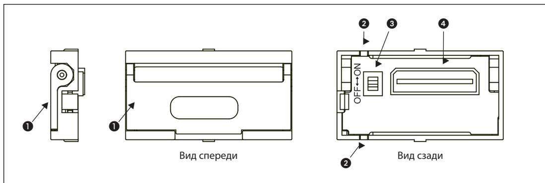
Рис. 10-2: Элементы управления кассет памяти FX3U-FLROM-16 и FX3U-FLROM-64
