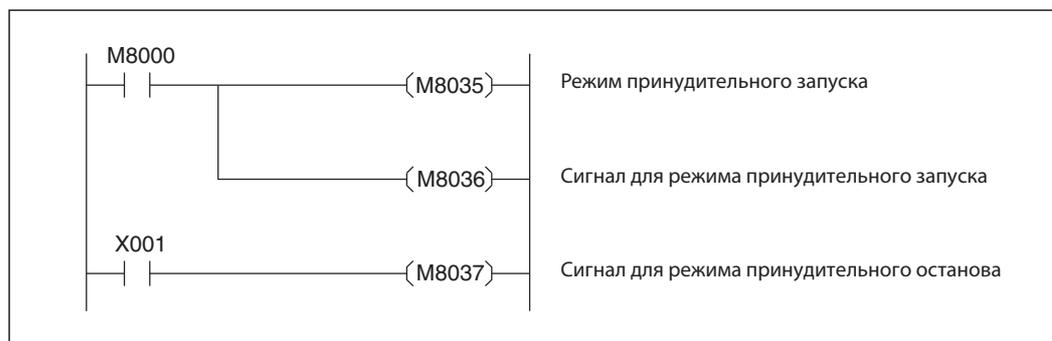
**Рис. 6-30:** Программа для запуска и останова контроллера посредством двух входов
