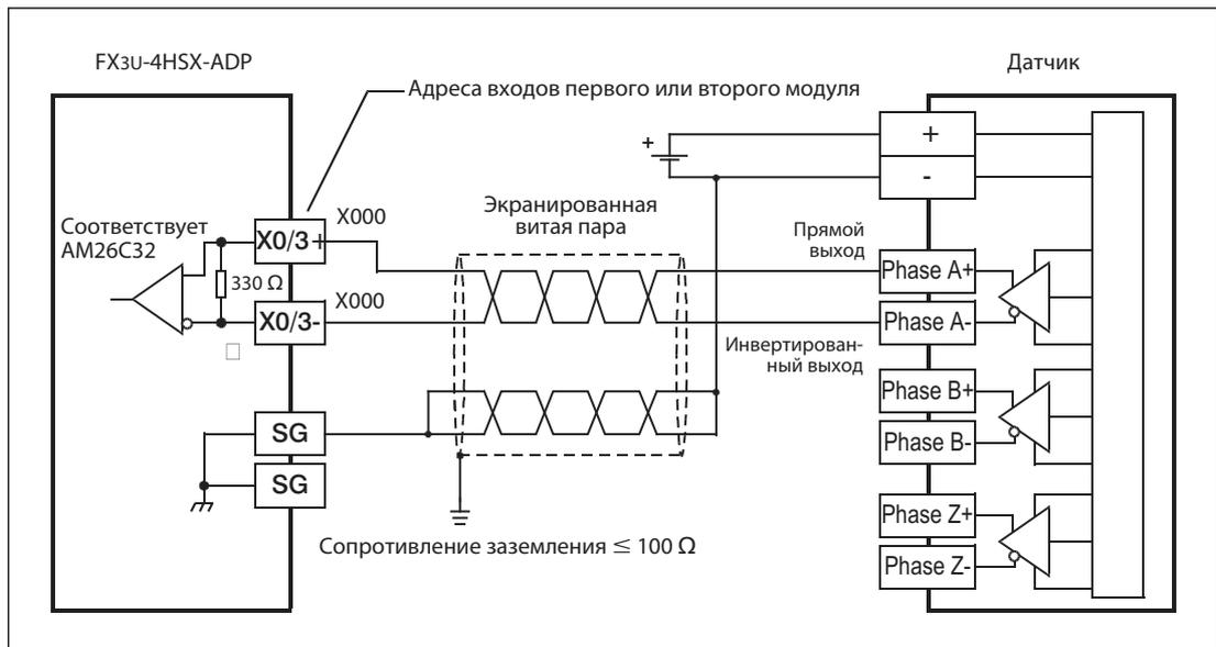
**Рис. 15-19:** Подсоединение датчика с дифференциальными выходами к адаптерному модулю FX3U-4HSX-ADP.
