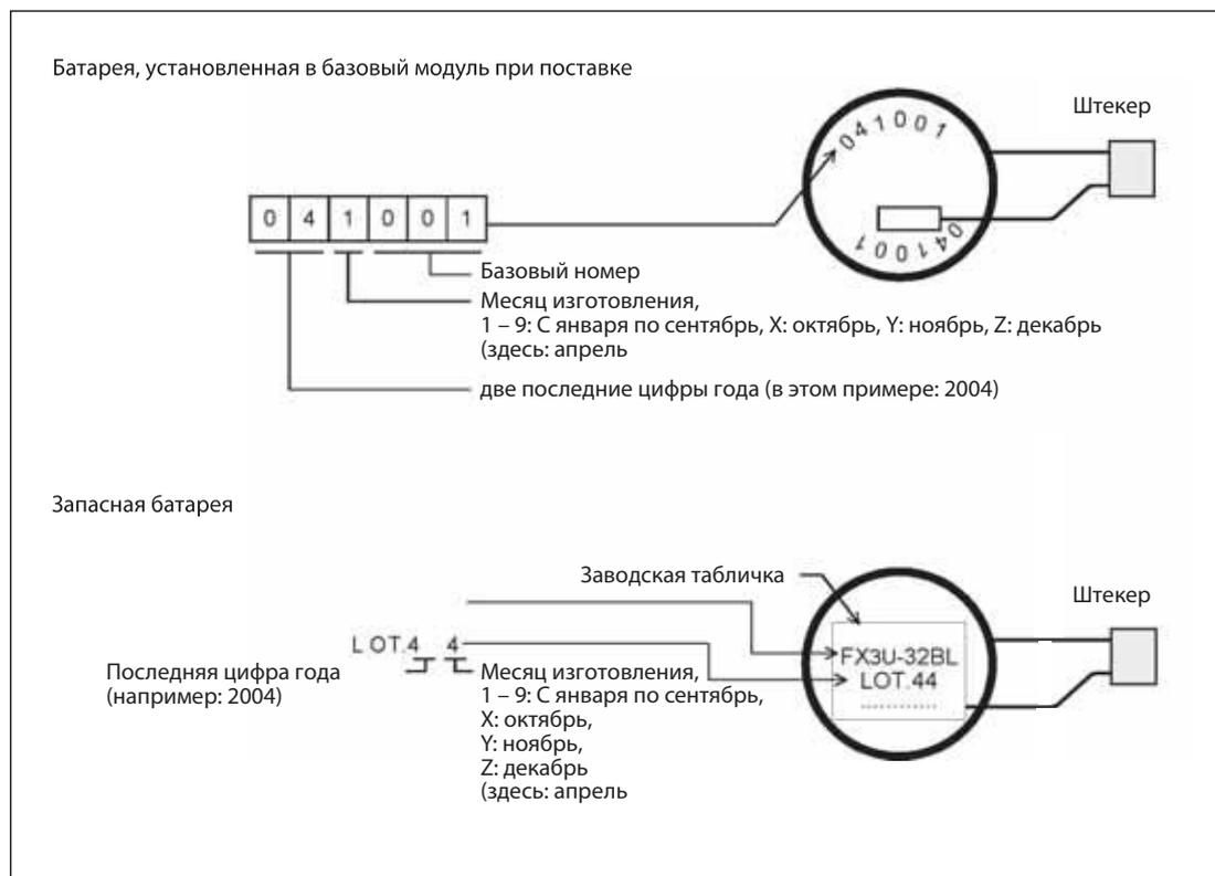
**Рис. 11-1:** Дата изготовления указана на батарее.
