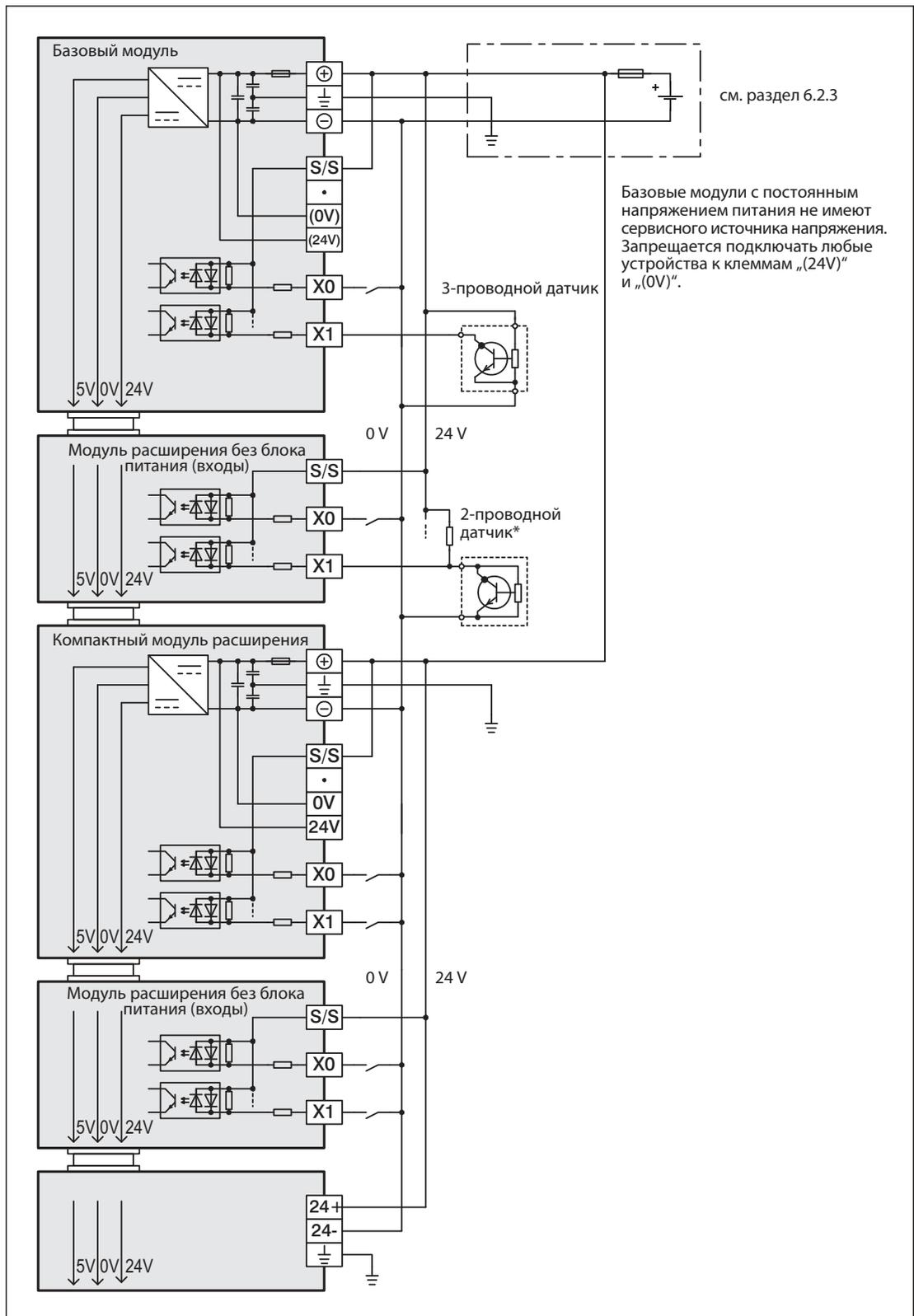
**Рис. 6-25:** Подсоединение коммутирующих минус датчиков (потребитель) к модулям с питанием от постоянного напряжения
