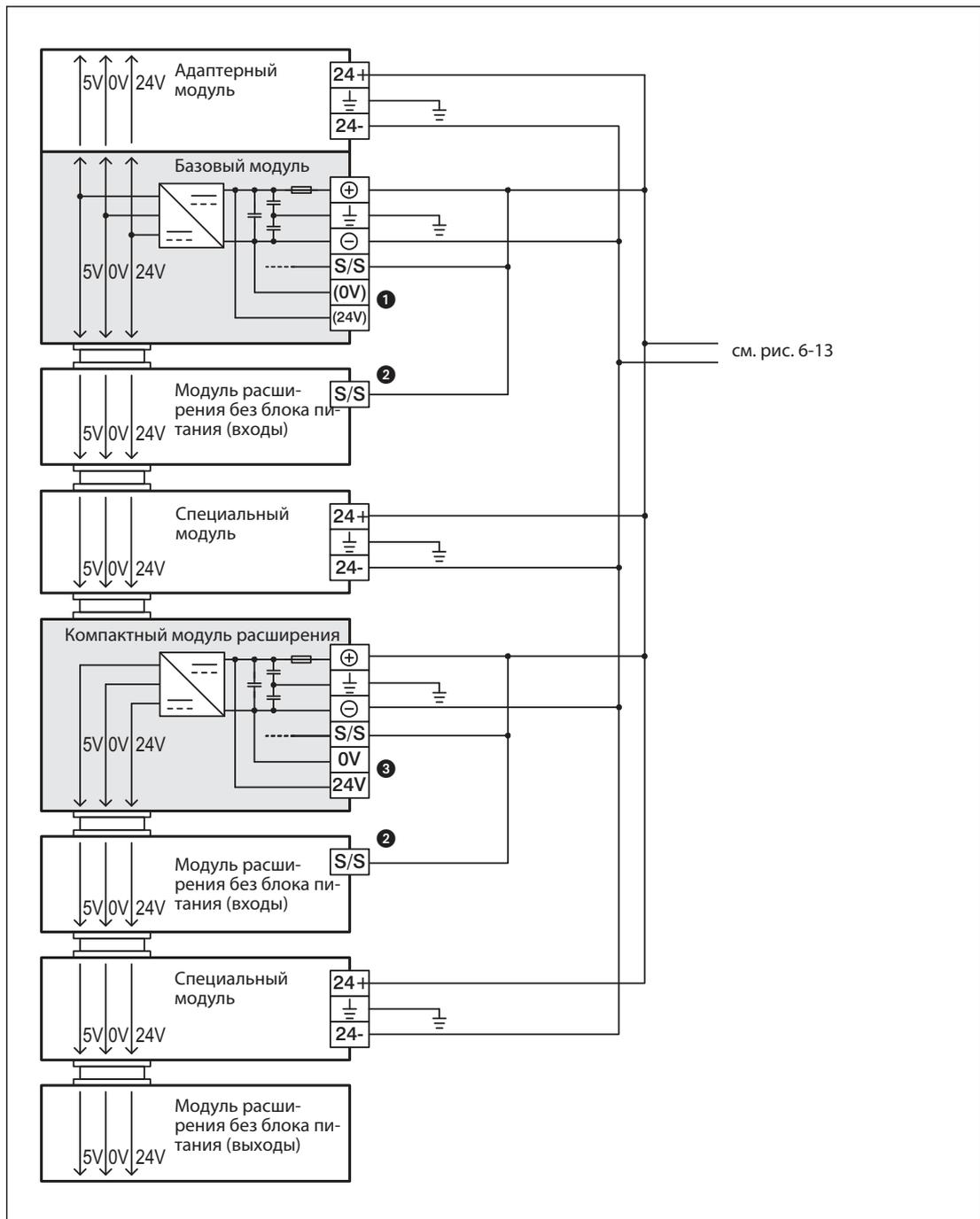
**Рис. 6-14:** Пример подсоединения для устройств с питанием от постоянного напряжения и коммутирующих минус датчиков
