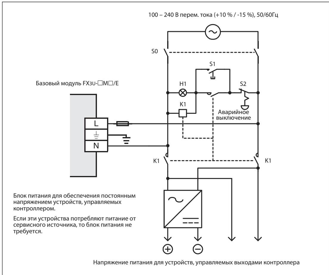
**Рис. 6-7:** Подсоединение источника питания базовых модулей FX3U с питанием от переменного напряжения
