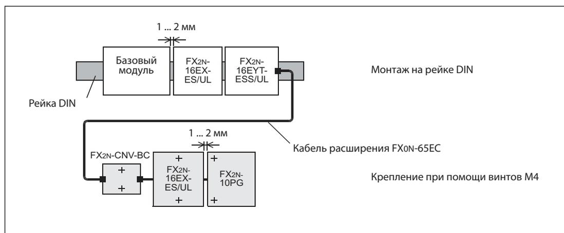
**Рис. 5-1:** Комбинированный монтаж: на рейку DIN и непосредственно в распределительном шкафу
