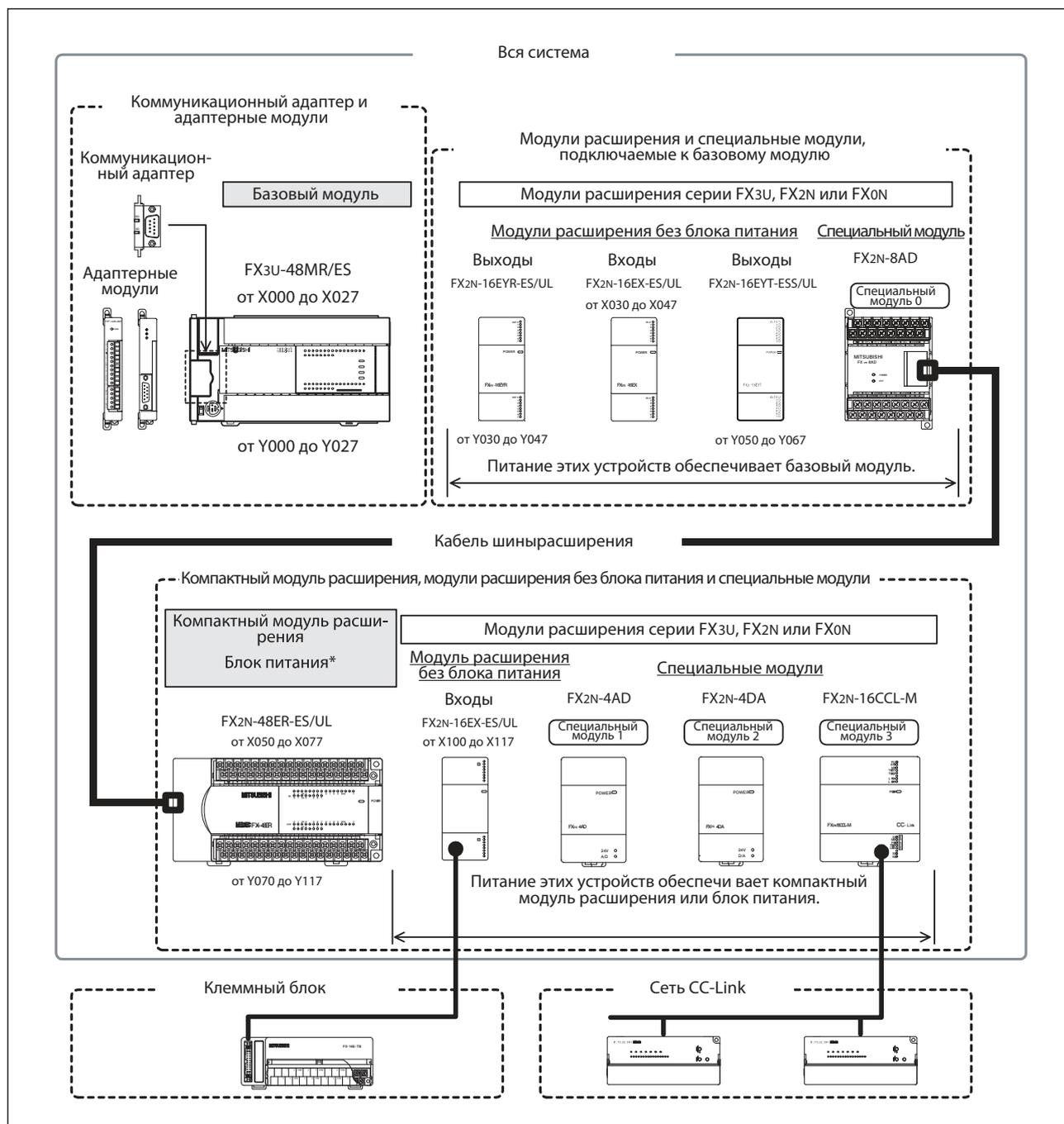
Рис. 2-8: Пример для системы с базовым модулем FX3U
