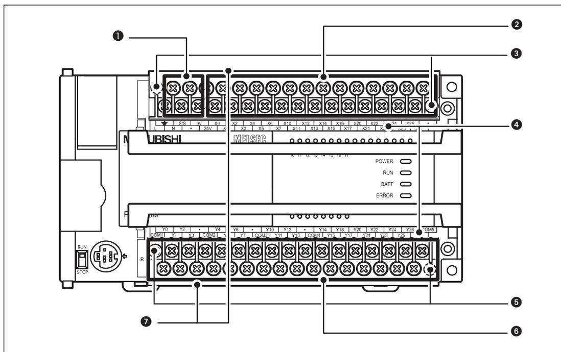
Рис. 4-2: Базовый модуль серии MELSEC FX3U с открытыми клеммными крышками
