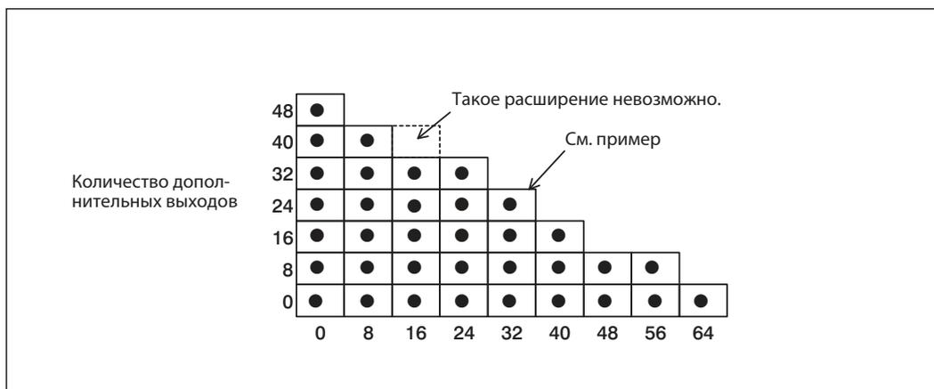
**Рис. 2-25:** Схема для планирования модулей расширения FX3U-48E□-E□/UL
