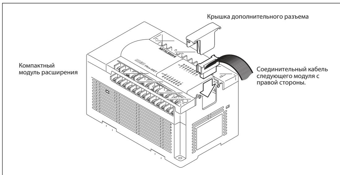
**Рис. 5-31:** Подсоединение модулей к компактному модулю расширения
