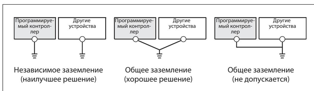
**Рис. 6-5:** Заземление программируемого контроллера
