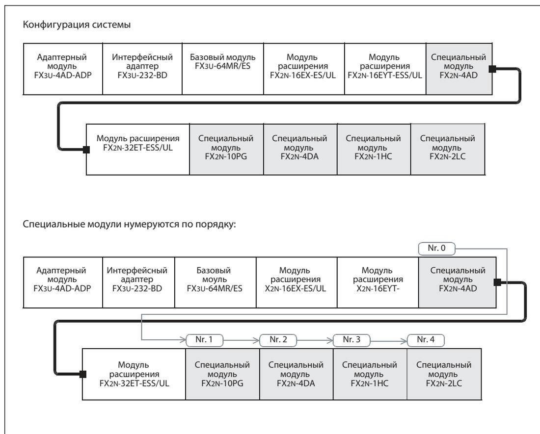
**Рис. 2-30:** Пример нумерации специальных модулей
