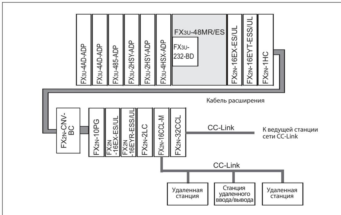
Рис. 2-27: Примерная конфигурация
