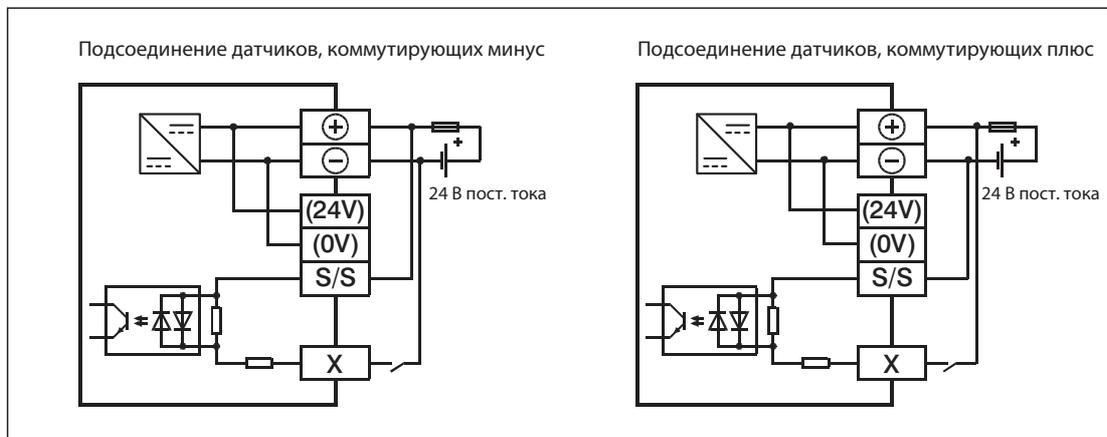
**Рис. 6-22:** При использовании базовых модулей с питанием от постоянного напряжения датчики подсоединяются к источнику питания.
