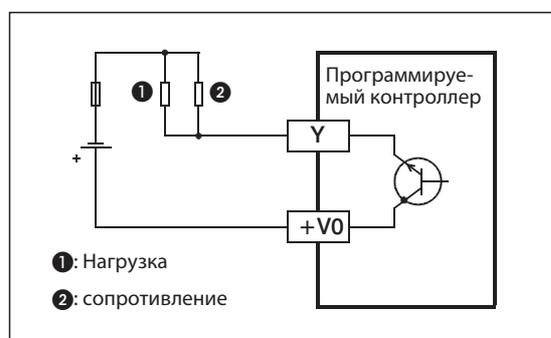
**Рис. 6-44:** *Подключение сопротивления параллельно нагрузке увеличивает подключаемый транзистором ток и сокращает время срабатывания при отключении*
