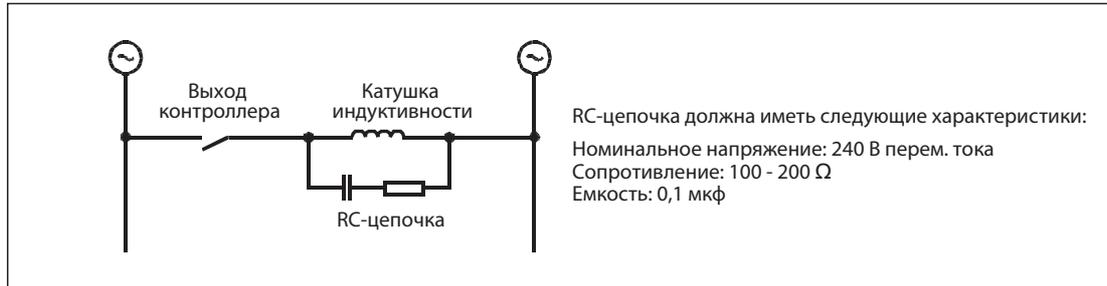
**Рис. 6-41:** RC-цепочка присоединяется параллельно нагрузке.
