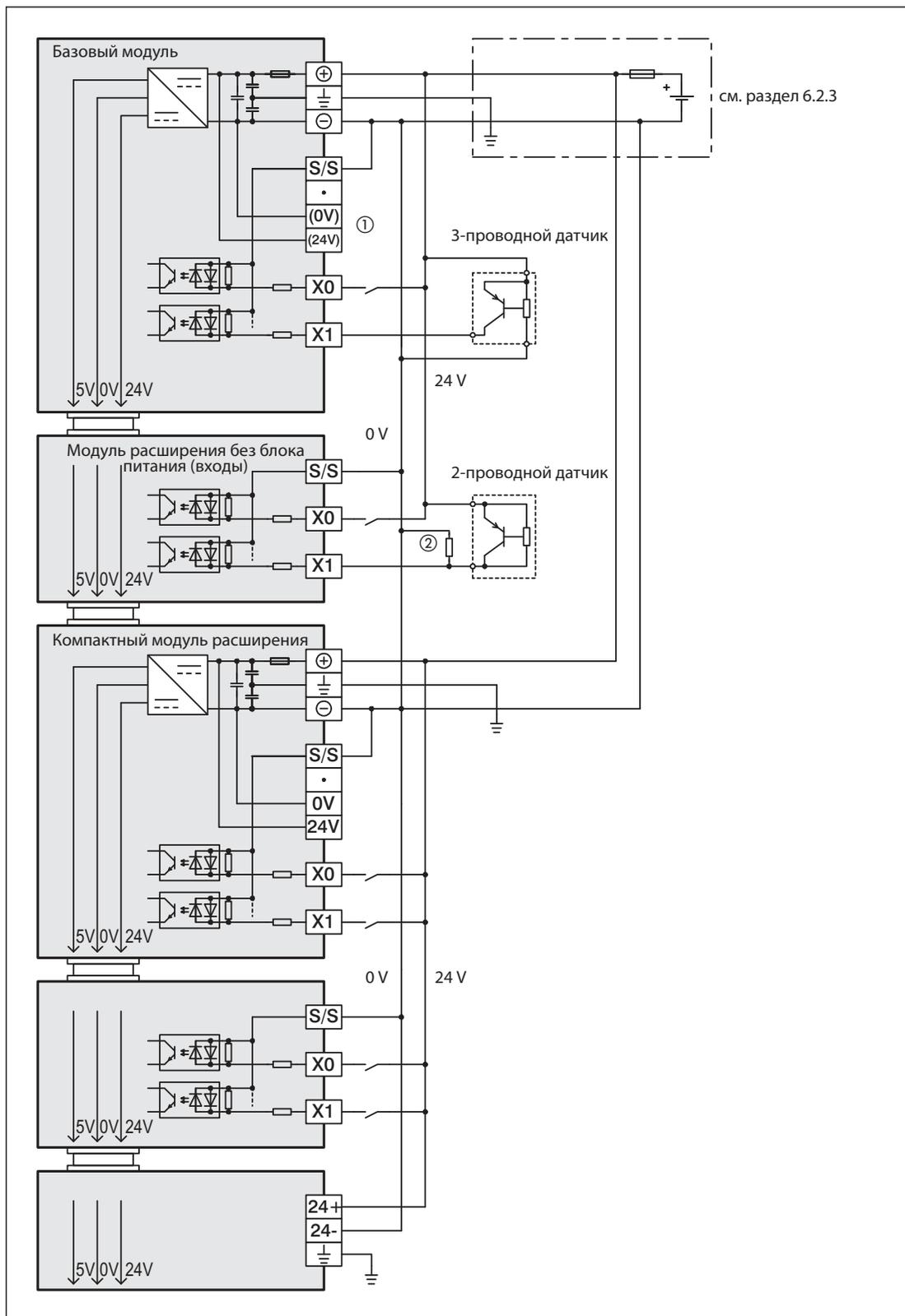
**Рис. 6-26:** Подсоединение датчиков, коммутирующих плюс, (источник) к устройствам с питанием от постоянного напряжения
