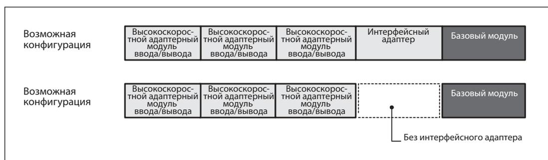
**Рис. 2-9:** Если подсоединяются только высокоскоростные адаптерные модули ввода/вывода, то от использования интерфейсного адаптера можно отказаться.
