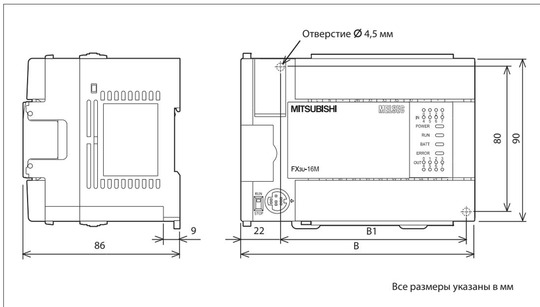
**Рис. 3-1:** Размеры базовых модулей FX3U-16M□ и FX3U-32M□
