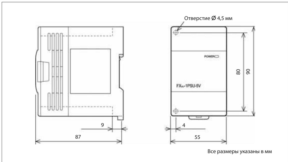
**Рис. 12-1:** Габаритные размеры блока питания FX3U-1PSU-5V
