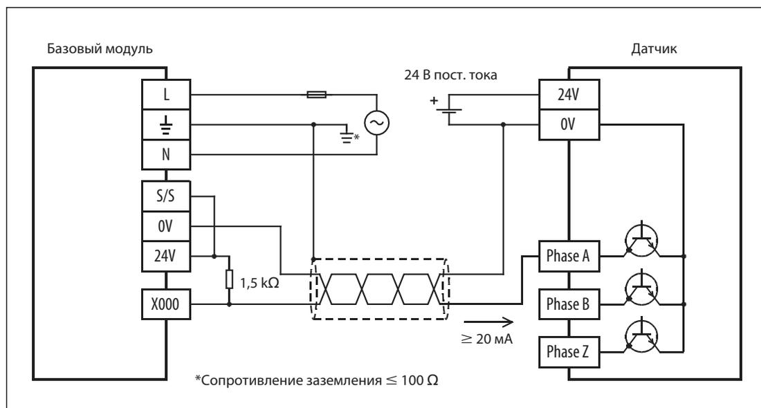
**Рис. 15-17:** К базовому модулю, сконфигурированному для коммутирующих минус датчиков, следует подсоединять датчик с транзисторными выходами n-p-n типа.
