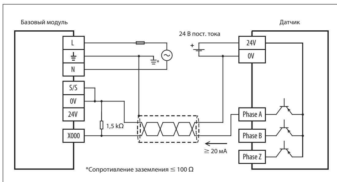
**Рис. 15-18:** К базовому модулю, сконфигурированному для датчиков, коммутирующих плюс, следует подсоединять датчик с транзисторными выходами p-n-p типа.
