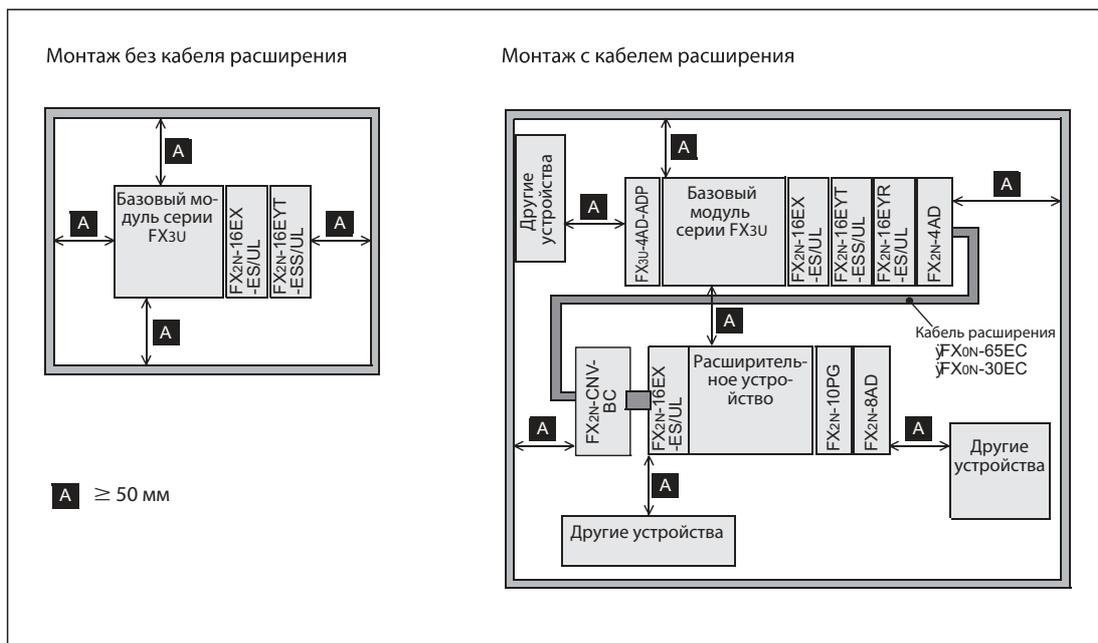
**Рис. 5-3:** Для обеспечения достаточного отвода тепла вокруг контроллера следует оставлять зазор шириной не менее 50 мм.
