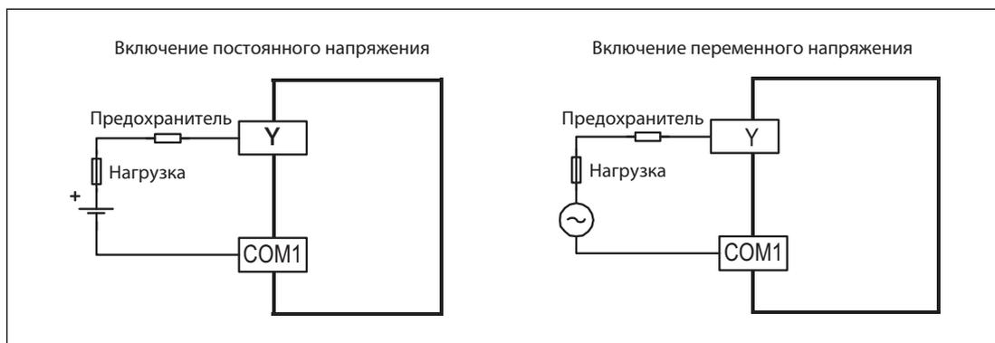
**Рис. 6-38:** Защита релейных выходов посредством предохранителя
