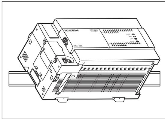
**Рис. 5-8:** Затем подвесьте базовый модуль на рейку DIN.
