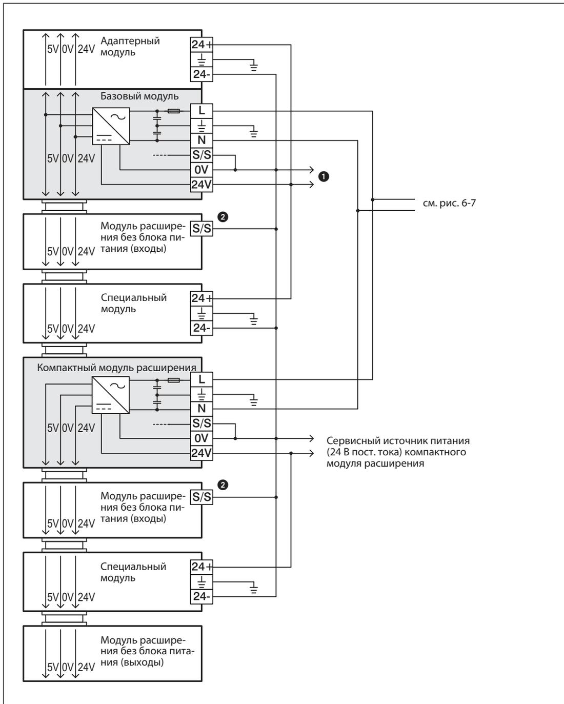
**Рис. 6-10:** Пример подсоединения устройств с питанием от переменного напряжения и коммутирующих плюс датчиков (см. раздел 6.3.2)
