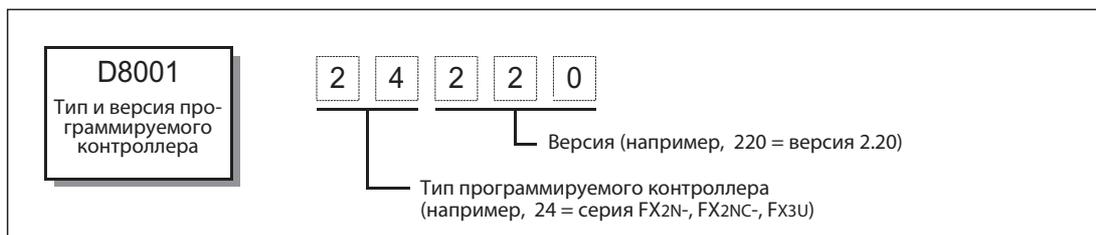
**Рис. 2-7:** Сведения о версии базового модуля в специальном регистре D8001
