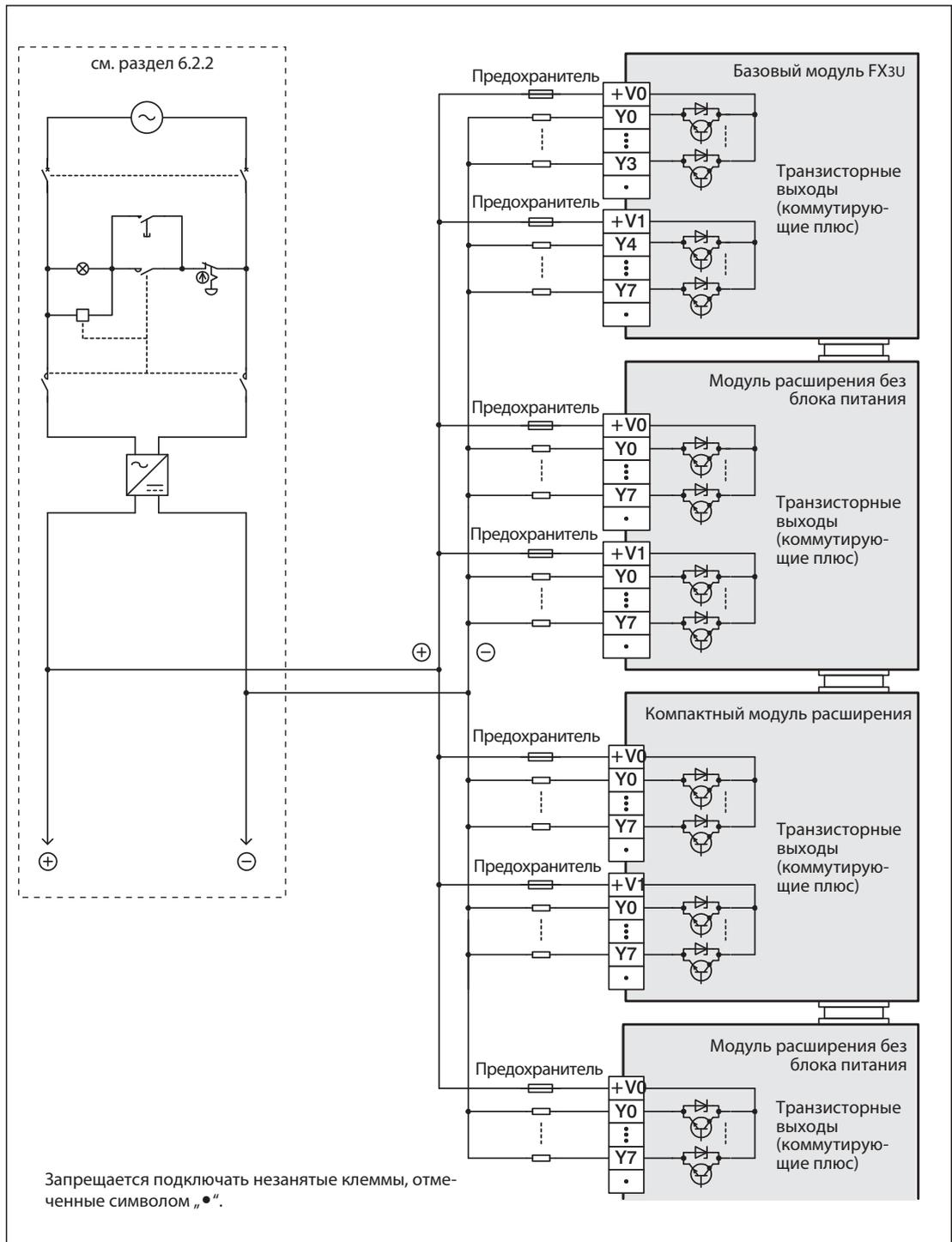
**Рис. 6-46:** Пример подсоединения транзисторных выходов, коммутирующих плюс, в устройствах с питанием от переменного напряжения
