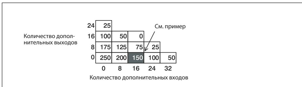
**Рис. 2-23:** Схема для планирования модулей расширения FX3U-32E□-E□/UL
