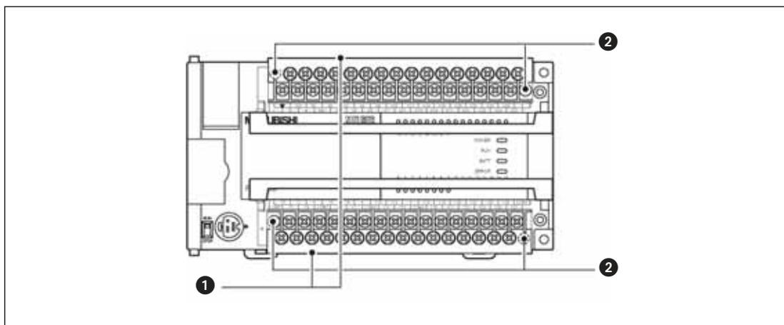
**Рис. 5-12:** Перед отсоединением клеммных блоков снимите защиту от прикосновения.
