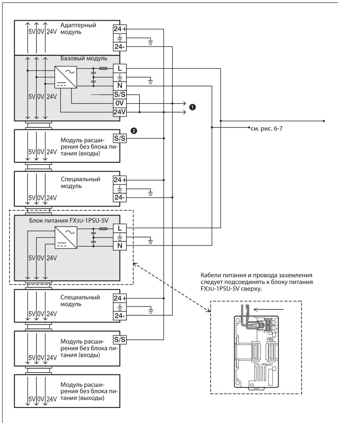
**Рис. 6-11:** Пример подсоединения дополнительного блока питания FX3U-1PSU-5V. Можно подсоединять коммутирующие минус датчики (см. раздел 6.3.2).
