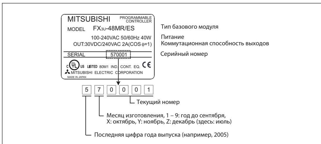
**Рис. 2-6:** Заводская табличка базового модуля серии MELSEC FX3U
