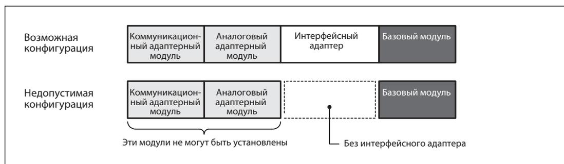
**Рис. 2-10:** Без интерфейсного адаптера в базовом модуле серии FX3U невозможно использовать аналоговые адаптерные модули или коммуникационные адаптеры.
