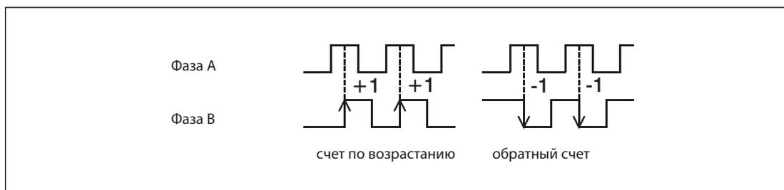
**Рис. 15-5:** Вид счета при регистрации фронта 2-фазным счетчиком
