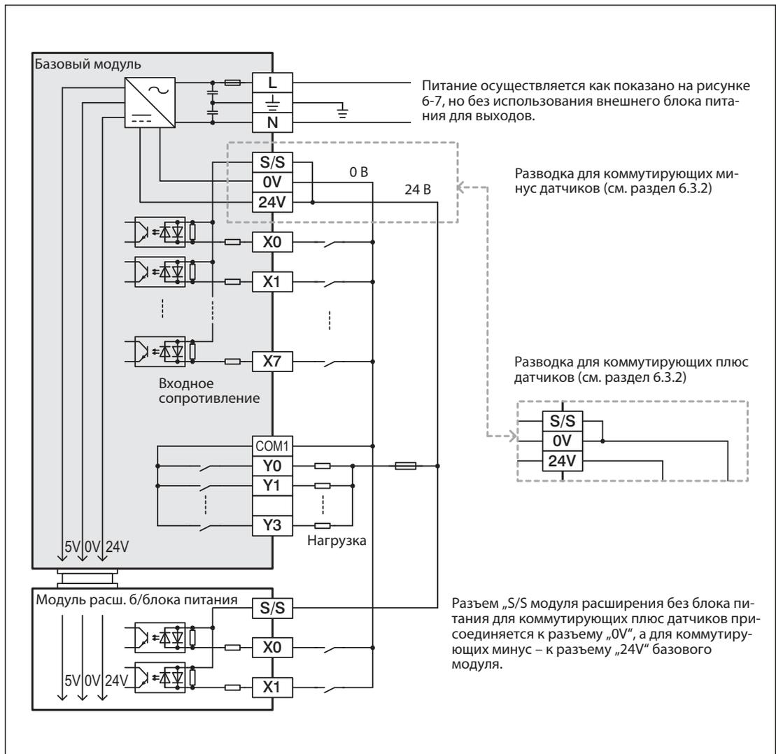
**Рис. 6-8:** В этом примере управляемые выходы нагрузки обеспечиваются питанием от сервисного источника.
