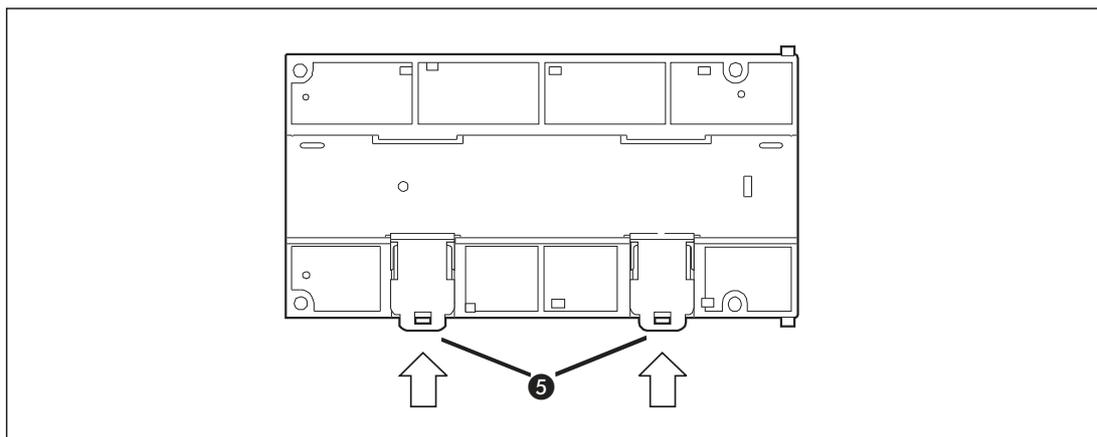
**Рис. 5-14:** После демонтажа снова вдавите монтажные накладки (5).
