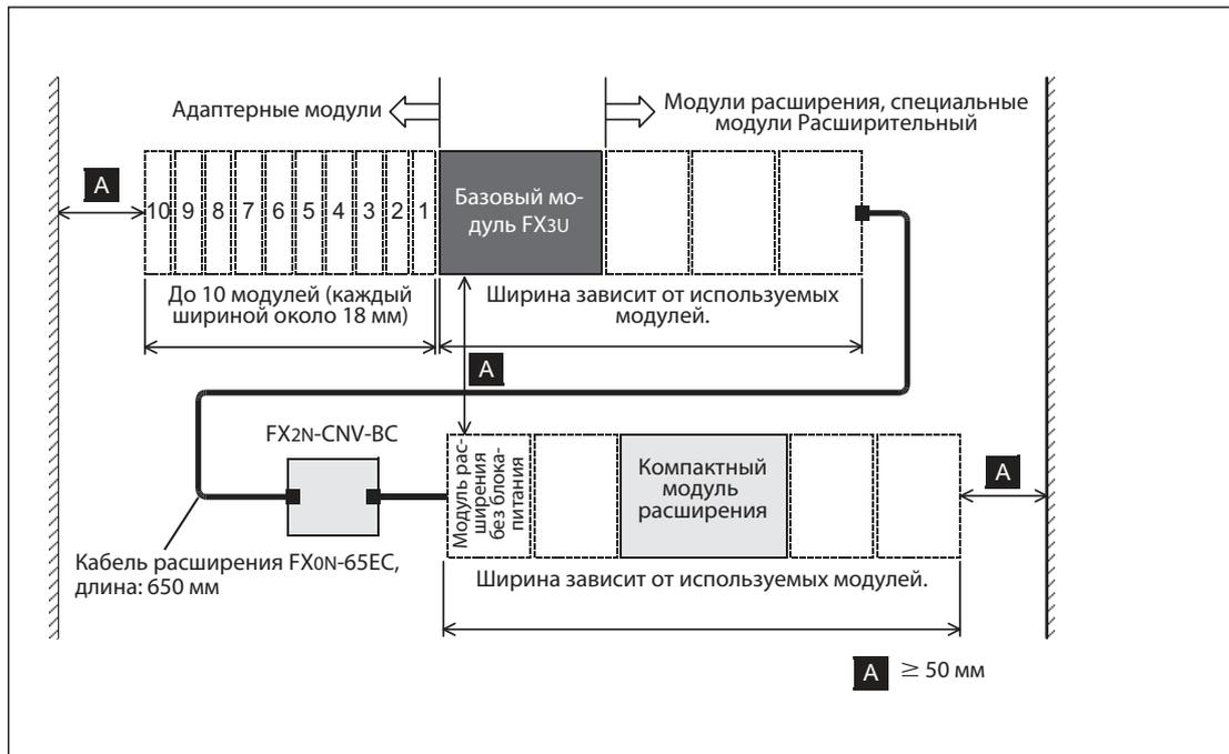
**Рис. 5-6:** Если в начале второго ряда устанавливается компактный модуль расширения или модуль позиционирования FX2N-10GM/FX2N-20GM, то необходимо использовать коммуникационный адаптер FX2N-CNV-BC.
