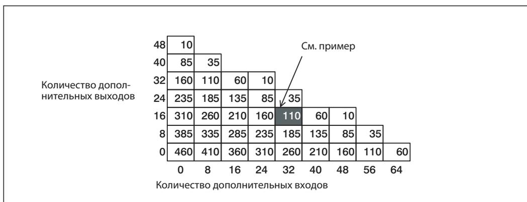
**Рис. 2-24:** Схема для планирования модулей расширения FX3U-48E□-E□/UL
