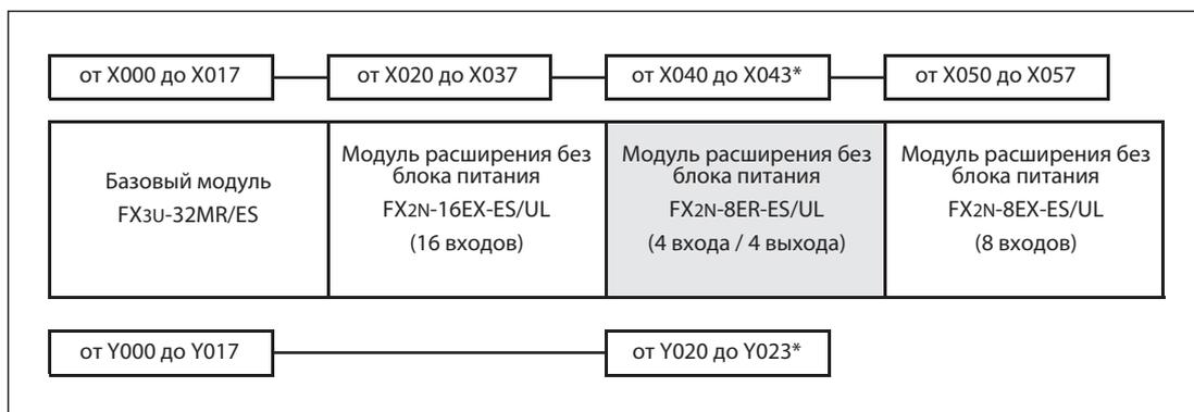
**Рис. 2-29:** Пример присвоения адресов в модулях расширения.
