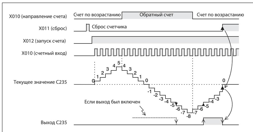
**Рис. 15-8:** Характеристика сигнала для представленного сверху примера программы
