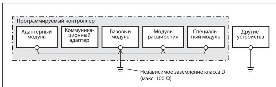
**Рис. 6-6:** Заземление базового модуля FX3U с присоединенными модулями
