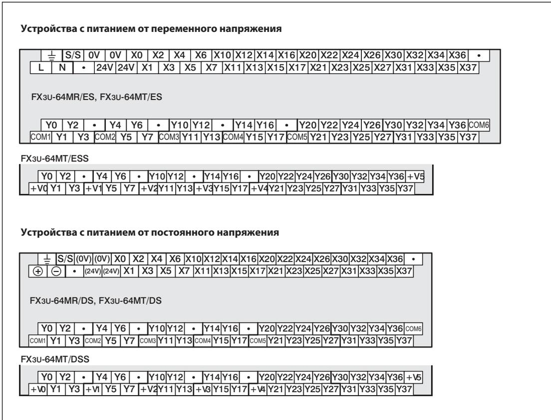
Рис. 4-9: Распределение клемм базовых модулей FX3U-64M□
