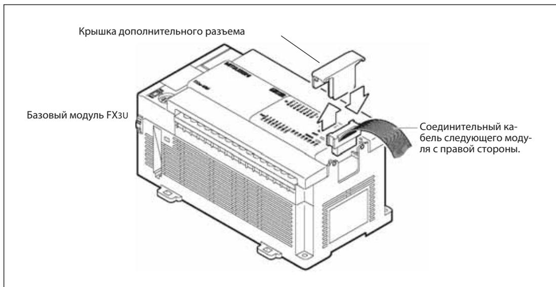
**Рис. 5-26:** Подсоединение модулей справа от базового модуля
