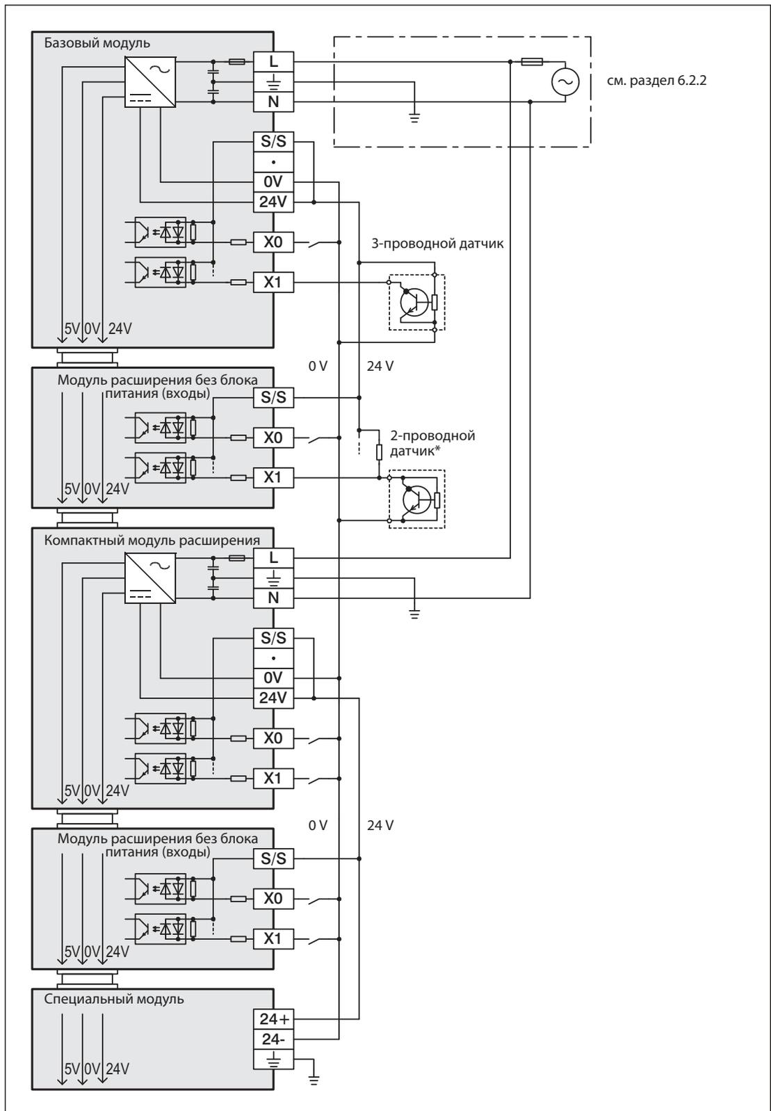
**Рис. 6-23:** Подсоединение коммутирующих минус датчиков (потребитель) к модулям с питанием от переменного напряжения
