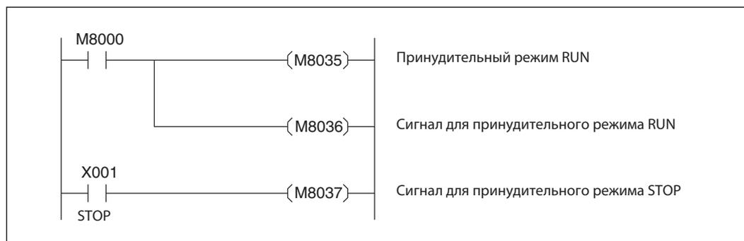
**Рис. 6-24:** Программа для запуска и останова контроллера с помощью двух входов
