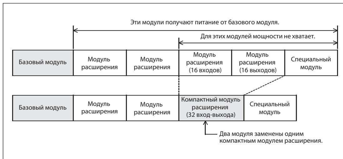
**Рис. 2-23:** Пример применения компактного модуля расширения
