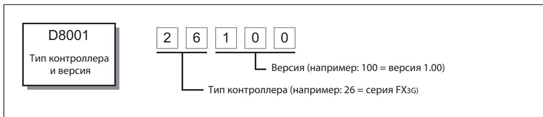
**Рис. 2-8:** Указание версии базового модуля в специальном регистре D8001
