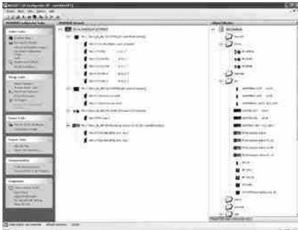
GX Configurator DP предназначен для конфигурирования открытых сетей Profibus DP. Пакет является 32-битным приложением, функционирующим под MS Windows® XP и Vista. Также возможно конфигурирование всех модулей Profibus для модулей серии MELSEC System Q, AnSH/QnAS и семейства FX. Благодаря поддержке GSD-файлов, обеспечивается возможность использования slave-модулей сторонних производителей.
