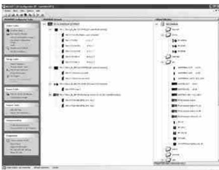
GX Configurator PN представляет собой инструментальное средство для конфигурирования модулей ввода/вывода Profinet. Данное приложение обеспечивает функции конфигурирования сети ввода/вывода Profinet, тестирования конфигурации и передачи настроек на модуль Profinet. Приложение GX Configurator PN оснащено различными функциями для передачи данных параметров. Модуль Profinet может устанавливаться на базовом шасси с непосредственным подключением компьютера или на другом контроллере в сети.
