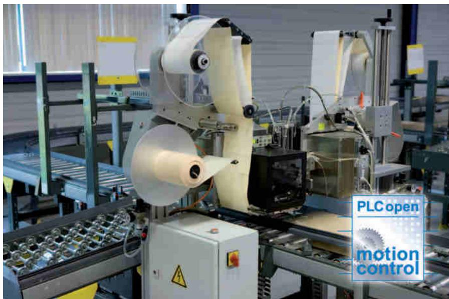
Маркировочная машина, управляемая ПЛК серии MELSEC L в комбинации с модулями управления движением Simple Motion.
