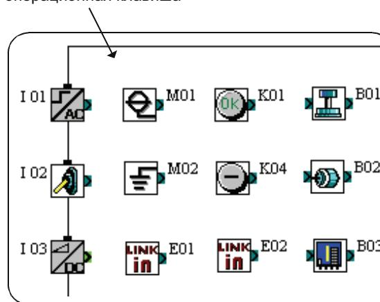
Значок цифрового входа, значок выхода для AS-интерфейса, управляющий бит
