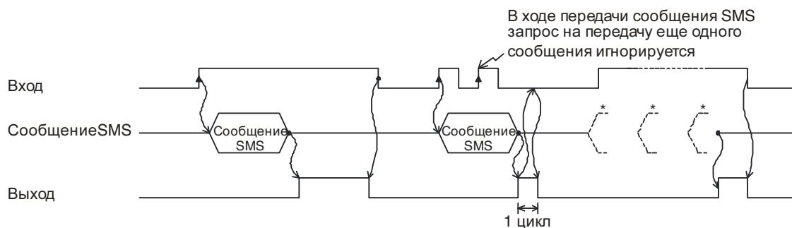
Пример программы VLS для функционального блока SMS
