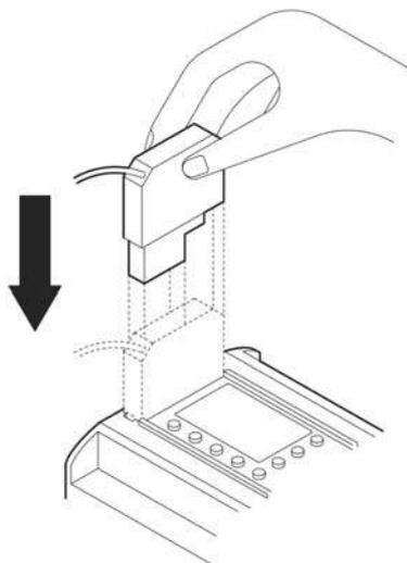
3) Отсоединение кабеля AL-232CAB
