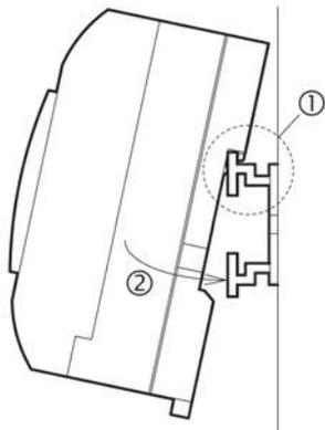
Совместите верхний край канавки, имеющейся на корпусе контроллера серии "Альфа-2", и предназначенной для монтажа на рельсе в стандарте DIN, с краем рельса (1), и надвиньте устройство на рельс.
