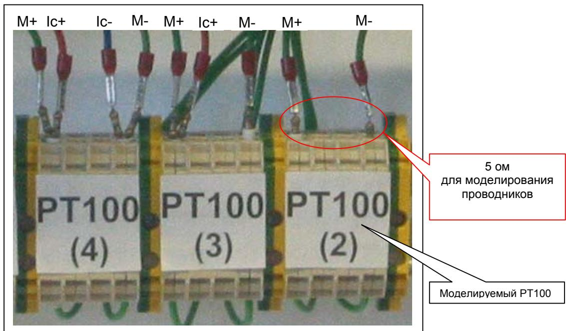
Рис. 5-3 Подключение клемм PT100
