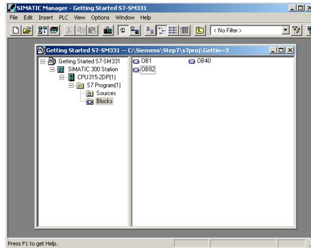
Рис. 6-1 Мастер создания проекта STEP 7 „New Project“: Результат
