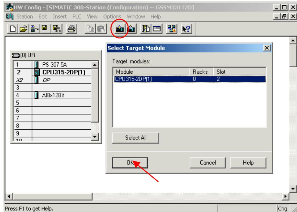
Рис. 6-1 Загрузка аппаратной конфигурации в CPU (1)
