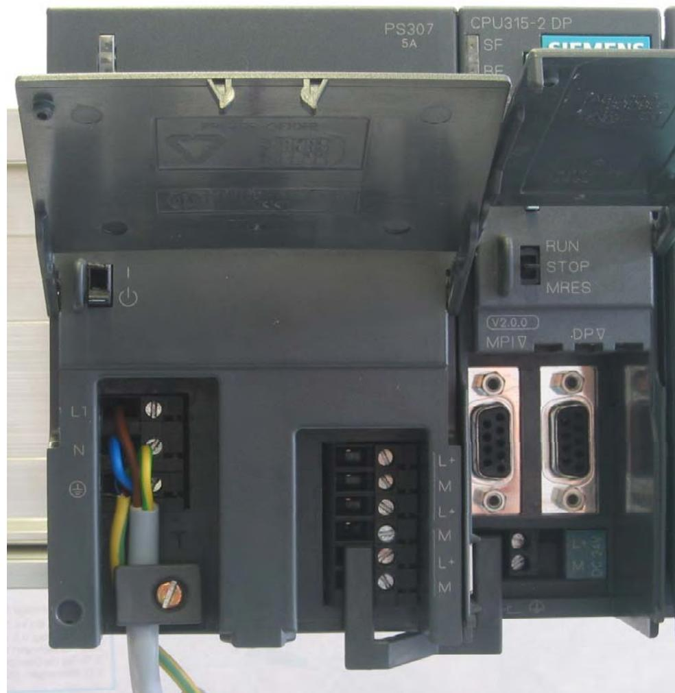
Рис. 5-1 Электрический монтаж блока питания и CPU
