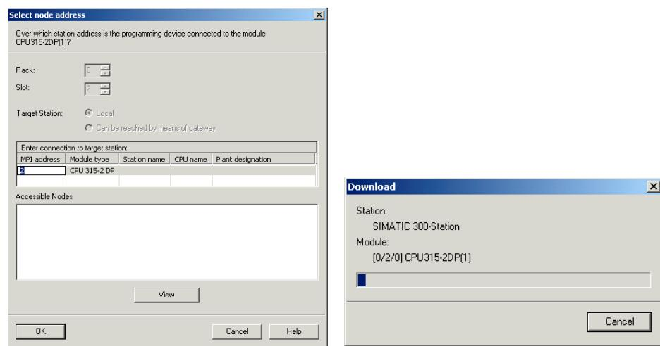
Рис. 6-2 Загрузка аппаратной конфигурации в CPU (2)
