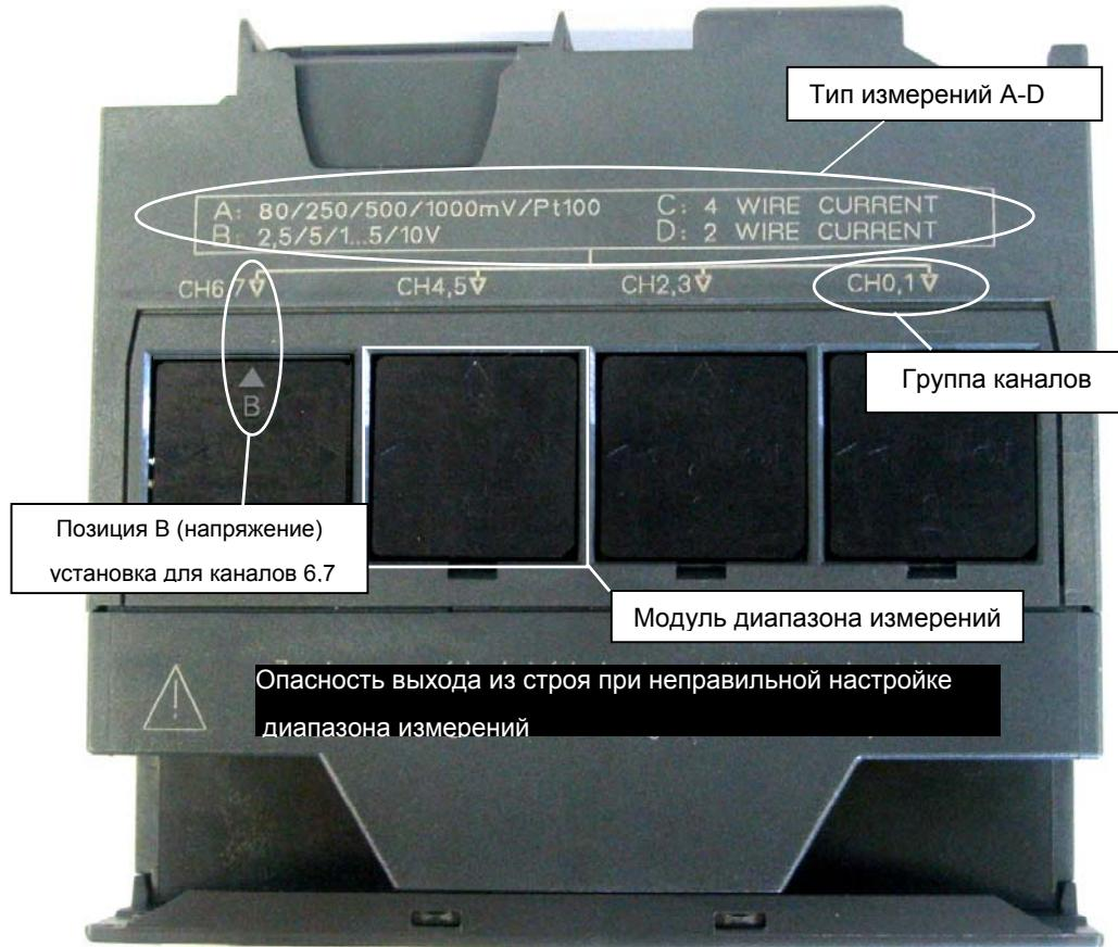
Рис. 4-1 4 модуля диапазона измерений со стандартной настройкой В (для измерения напряжения)
