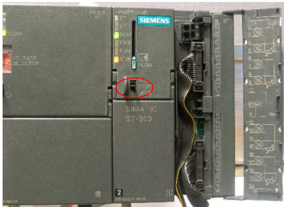
Рис. 5-1 Правильно выполненный монтаж: CPU в режиме STOP
