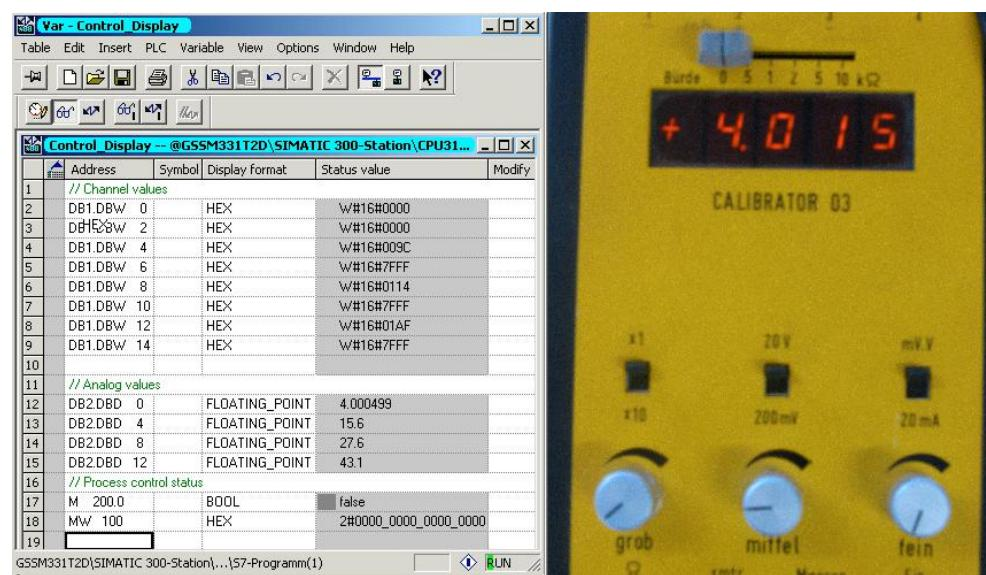
Рис. 9-2 Аппаратное прерывание : Выход за граничное значение канала 0
