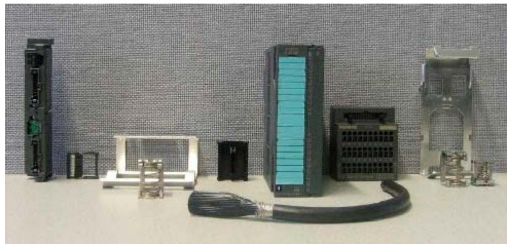
Рис. 4-1                    Компоненты SM331 с соединителем SIMATIC TOP connect
