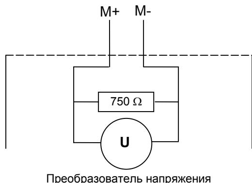
Рис. 5-2 Основная электрическая схема преобразователя напряжения
